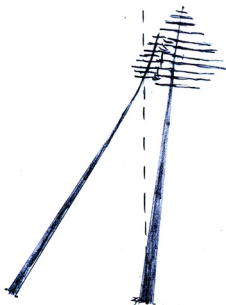
Fig. 112 Déchaussement partiel sans plastification
