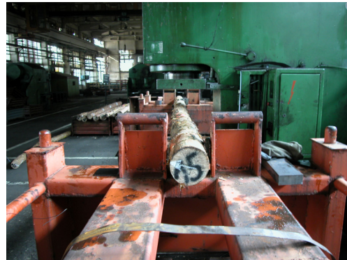
Fig. 32 Assise droite du billon, vue latérale de la presse hydraulique
