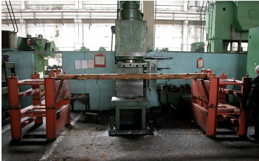
Fig. 31 Installation des essais de fléchissement des billons
