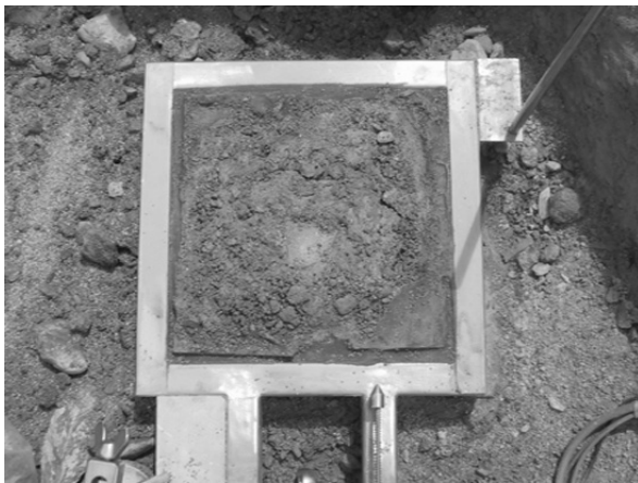
Fig. 5-6 Abgescherter Probe, effektive Scherfläche Versuch V04, Gruben.
