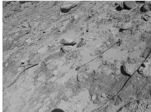
Fig. 4-41 Abgerissene Sonden, Versuch 4 (2000).
