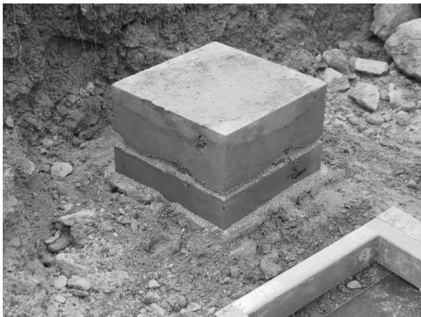
Fig. 5-5 Probe vor Abschervvorgang.
