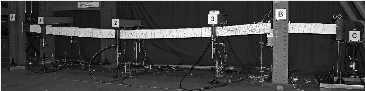
Bild 4.21 Versuchskörper T1 nach dem Bruch.
