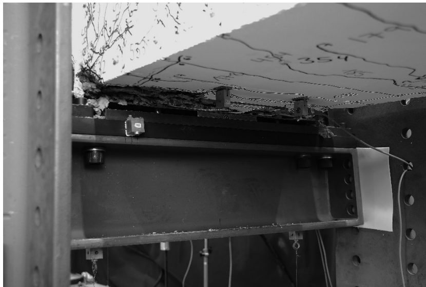
Bild 4.67 Bruchzonen des Versuchskörpers T5 vor dem Ausbau; (a) bei Joch 1; (b) bei Joch 2; (c) bei Zwischenaufleger B.
