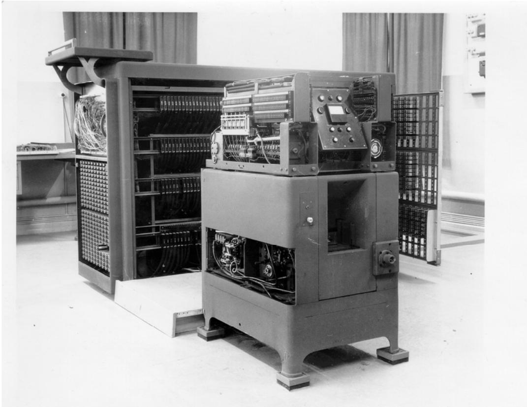
*M9 in der Spinnerei & Weberei Dietfurt, vorn die Lochkartenstation, hinten das Rechen- und Speicherwerk, rechts hinten ein herausgeschwenkter Relaisrahmen. Die Recheneinheit hatte rund 2200 Relais.
