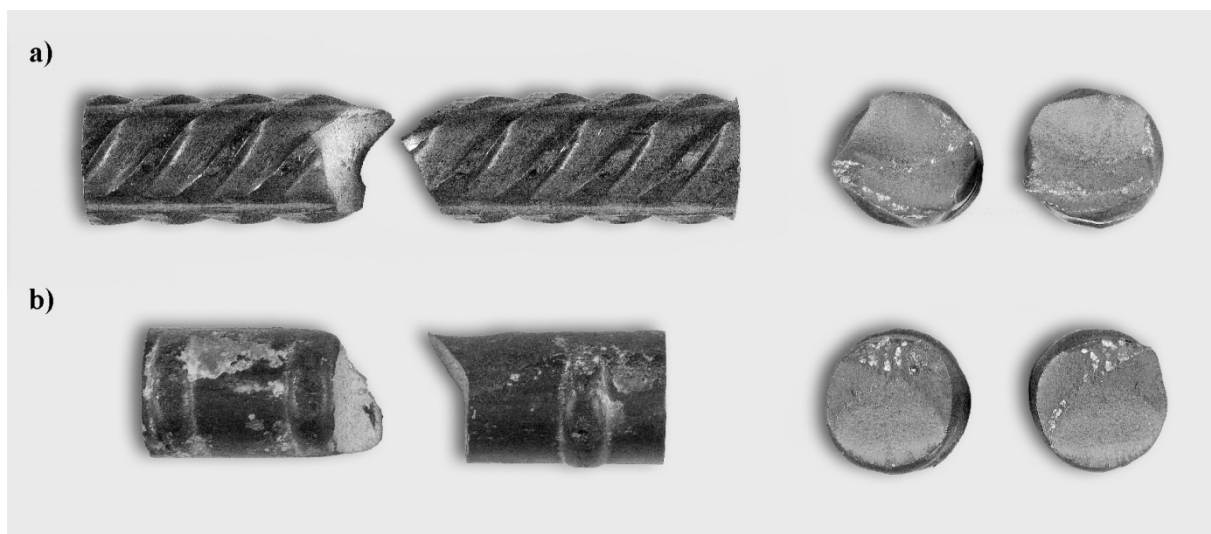
Bild 4.2: Ermüdungsbrüche von Betonstahl-Stäben: (a) aus warmgewalztem Ringmaterial; (b) aus naturhartem Stahl. Längsansicht und Draufsicht auf beide Bruchflächen.
