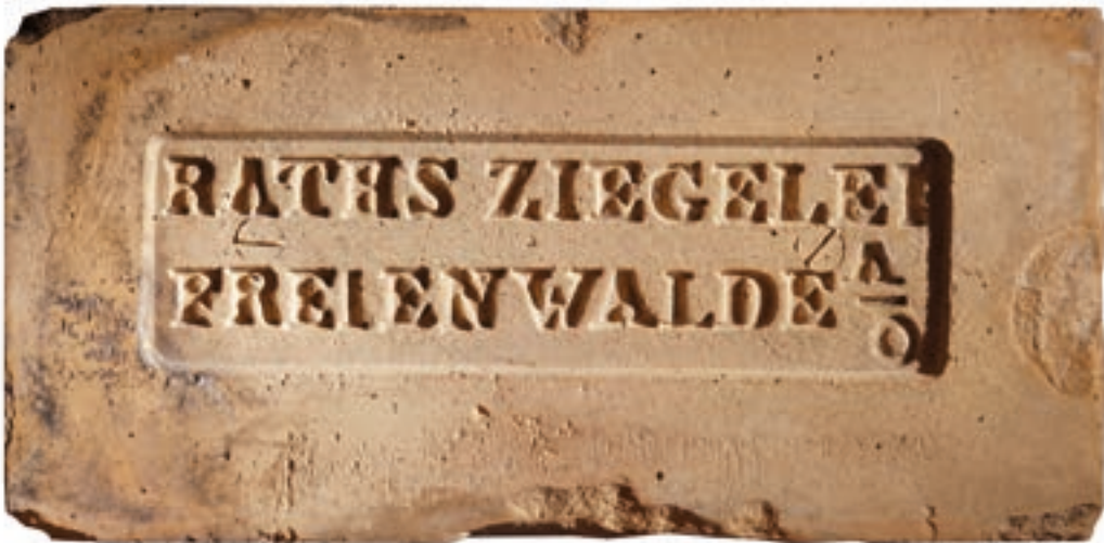
285 Nachgepresster Stein der Raths-Ziegelei Freienwalde aus der Privatsammlung Horst Hartwig. Gut sichtbar die Abdrücke der Schlitzschrauben zur Befestigung der Pressplatte mit dem Aufdruck der Ziegelei.
