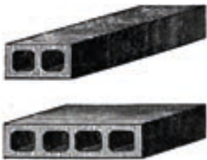
149 Hohle Steine im Format gewöhnlicher Mauerziegel, längsgelochter Läufer und quergelochter Binder.
