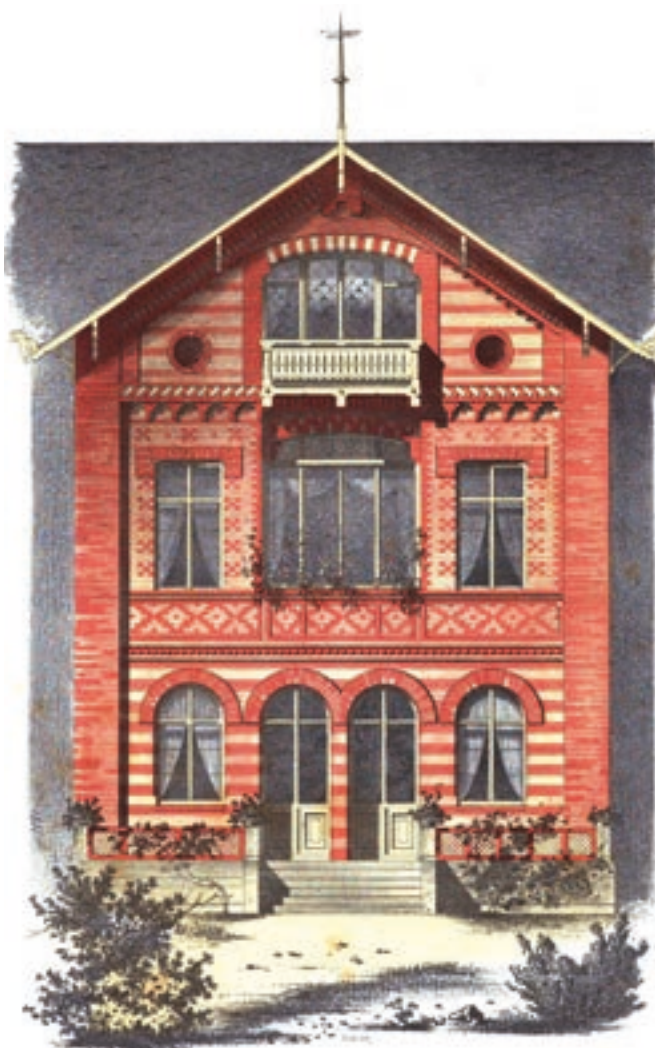
532 Stark verzierte Giebelfassade eines Landhauses, wie von Ludwig Degen als Gestaltungsbeispiel für den Ziegel-Rohbau abgebildet.
