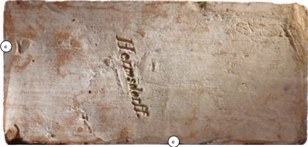
284 Hermsdorfer Ölstein der Borsig-Werke vor dem Oranienburger Tor aus der Privatsammlung von Horst Hartwig. Feinere Schlieren als bei Wasserstrichziegeln (a), abgeschnittener Wulst auf den Sichtflächen (b) sowie abgeschnittene Grate auf der gegenüberliegenden Lagerfläche (c).
