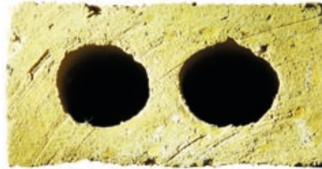
314 Spuren des radial geführten Schneidedrahtes, hier jeweils an den Binderseiten. Oben an einem horizontalen Vollverblander der Bad- und Waschanstalt Winterthur, 1864, unten an einem Langlochverblander aus der Sammlung Horst Hartwig.
