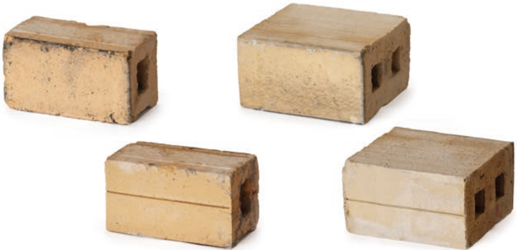
211 oben \frac{1}{4} - und \frac{1}{2} -Verblender der Siegersdorfer Werke, oben jeweils die vorder- und unten die rückseitige Ansicht. Beide Ziegel haben eine horizontale Rille, um die bei der Qualitätskontrolle als schlechter befundene Seite unbrauchbar zu machen. Der \frac{1}{4} -Verblender zeigt außerdem die leicht zurückversetzte Erhöhung, die in der Produktionsphase als Kantenschutz diente, als die im Bild nach oben zeigende Fläche nach unten zeigte.
