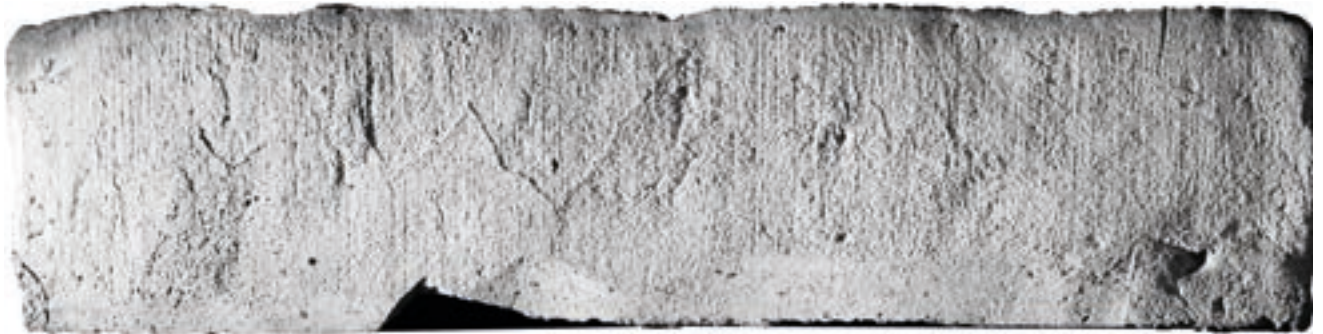
120 mitte Oberflächenspur an einem Hermsdorfer Läufer der Kirche St. Michael. Feine Schlieren, beidseitiger Zuschnitt der Kanten auch parallel zur Lagerfläche, an der unteren Kante offenbar etwas zu stark beschnitten.
