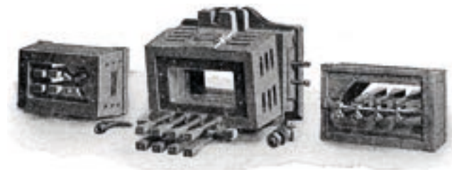
326 Zweiteiliges Mundstück von Raupach, hier mit Einsätzen für gelochte Formsteine.
