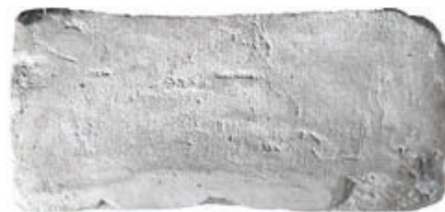
134 Ziegel der Borsig-Werke vor dem Oranienburger Tor, erhalten in einer Privatsammlung. Ölstein aus Hermsdorf, in der Lagerfläche mit dem Schriftzug des Herstellers gestempelt. Unter Streiflicht zeigen sich auf der Binderseite die feinen Schlieren und der Abschnitt des Wulstes parallel zur Sichtfläche, was die Verwandtschaft mit vielen der vorher abgebildeten Ziegeln verdeutlicht.
