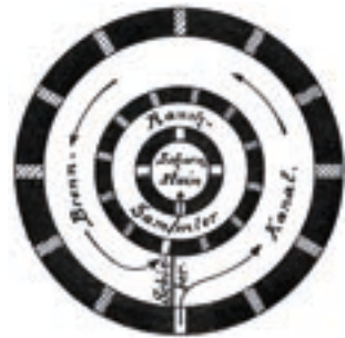
363 Funktionsprinzip des Ringofens.
