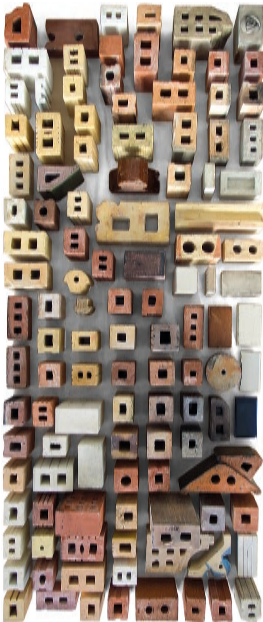
207 Eine Zusammenstellung der Langlochverblender aus der Privatsammlung Horst Hartwigs veranschaulicht das gegen Ende des 19. Jahrhunderts erhältliche Verblendsteinsortiment. Diverse Farben, Formen und im Detail andere Profilausbildungen unterschiedlicher Hersteller waren über das 1879 standardisierte Verblendsteinmaß miteinander kompatibel und daher beliebig kombinierbar.
