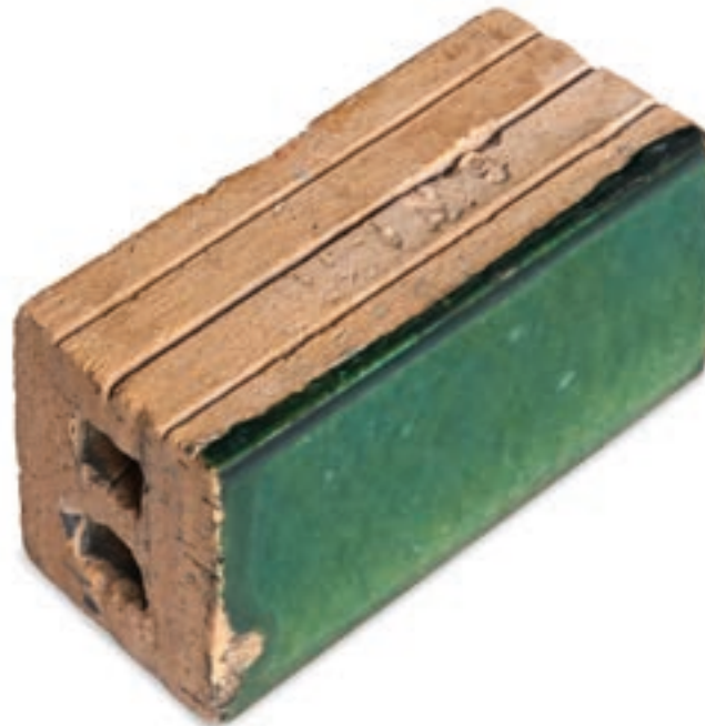
354 Grün glasierter \frac{1}{4} -Verblander. Auf der Lagerfläche ist eine vermutlich der Glasur entsprechende Nummerierung eingepreßt.
