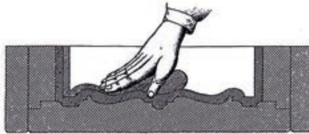
332 Terrakottaherstellung in Formen.
