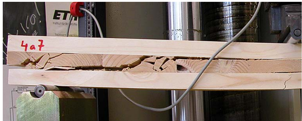
Abb. 2 Kombiniertes Schub- und Biegeversagen eines Balkenversuches Fig. 2 Combined shear and bending failure of a beam test
