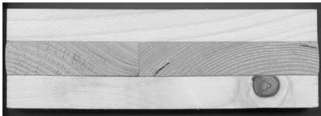
Abb. 23 Herausquellen der querliegenden Lagen im Feuchtklima bei 93% rel. Luftfeuchte Fig. 23 Swelling out of the transverse situated lamellas in the wet climate at 93% relative humidity
