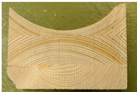
(d) CS next to failed section ( l \approx 4.7 m)
