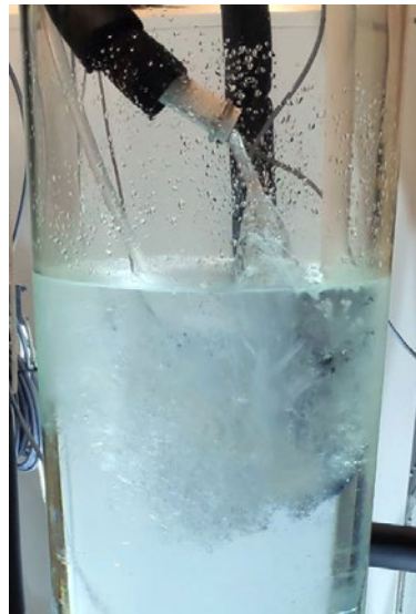
Abbildung 5: Behälter aus Glas mit Wasser und obenauf schwimmenden Eiskristallen. Über einen Schlauch (gebogen; oben links) fliesst unterkühltes Wasser in den Behälter, das zu Eisbrei (Ice slurry) wird, sobald es auf die schwimmenden Eiskristalle trifft.
