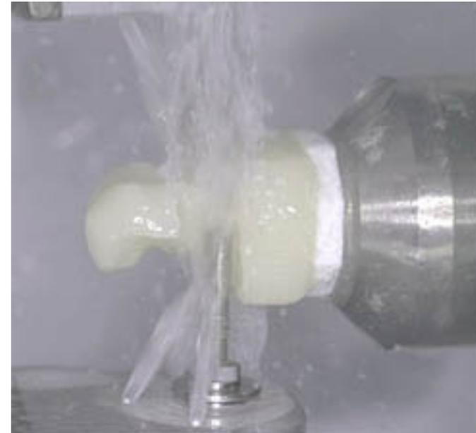
Bild 2: Formschleifen eines Zahnersatzes aus einem Keramikblock [1]
