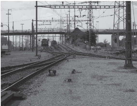
Abbildung 3: Sicht von der Richtungsgruppe auf den Ablaufberg mit zwei Höhen, eine für den Sommer und eine für den Winter. (Foto: K. Elsasser)
