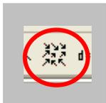
Diese Taste berechnet das dichtere Linkfile mit Hilfe der oben beschriebenen Transformation der Rasterpunkte in der Datei points\_ch.txt
