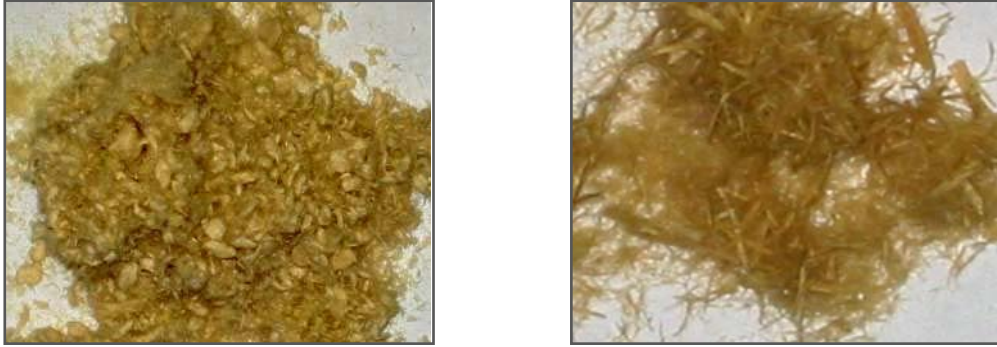
Abb. 3-38: Schliffarten, links: Holzschliff, rechts: Hackschnitzelschliff (Gutwasser 2005)
