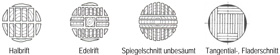
Abb. 2-10: Rift-, Spiegel- und Fladerschnitte (Fronius 1989a; Lohmann und Annies 1998)
