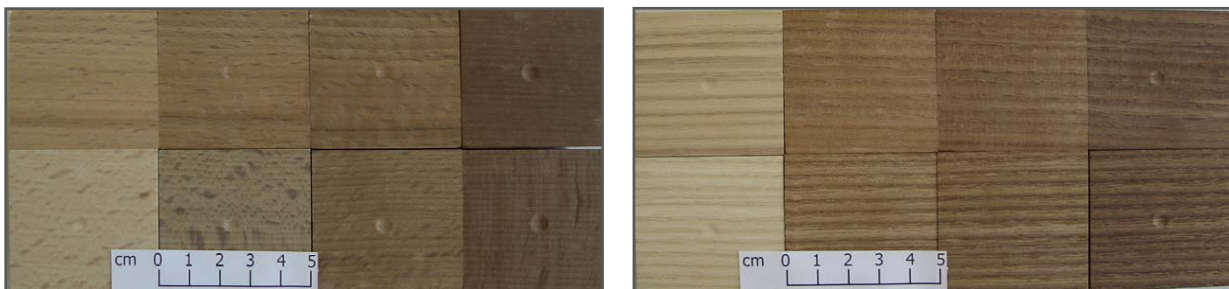
Abb. 3-35: Behandlung von Buche (links) und Esche (rechts) bei 180 °C und unterschiedlicher Dauer. Von links nach rechts: unbehandelt, 6h, 12h, 24h (Oelhafen 2005)
