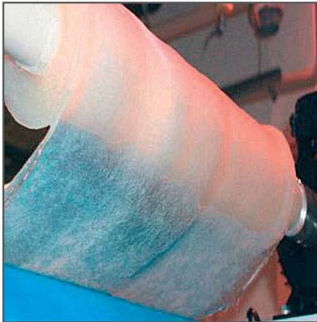
Abb. 3-40: Im Lyocellverfahren hergestellter Vlies (Fink et al. 2009)
