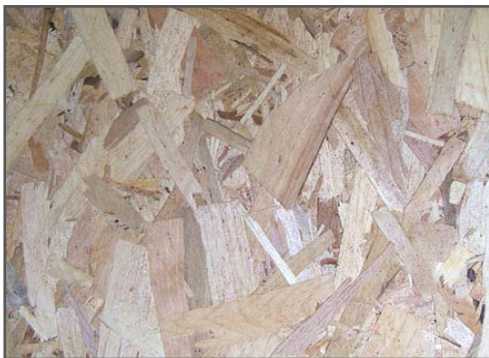
Abb. 3-30: Oberfläche einer OSB (Verena Krackler)
