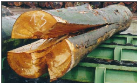
Abb. 2-1: Rissbildung in Buche durch Eigenstressungen (Autorenkollektiv 2001)
