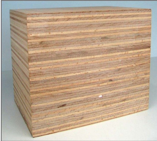
Abb. 3-29: Ausschnitt einer Knotenplatte aus Buchenfurnier der Hess & CO. AG (Verena Krackler)
