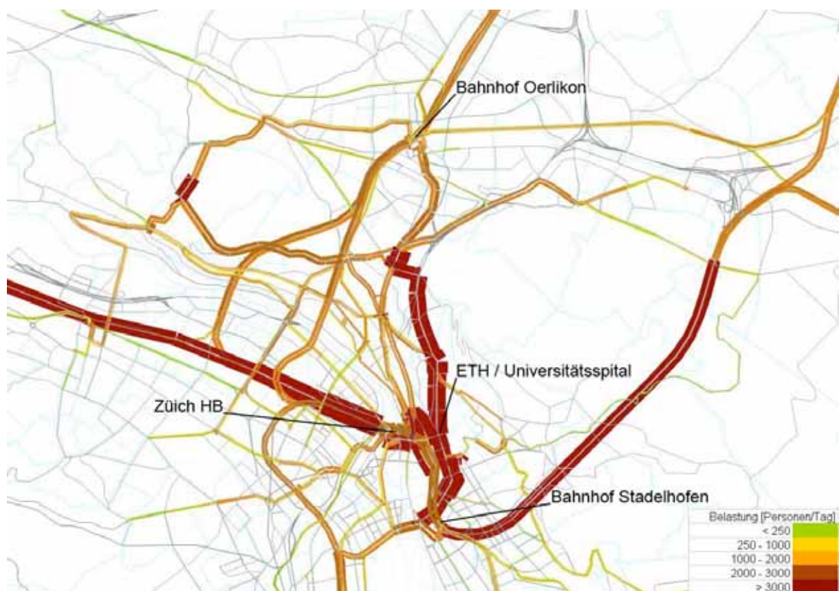
Abbildung 23 Durch das Hochschulgebiet erzeugte ÖV-Netzbelastungen an einem durchschnittlichen Wochentag
