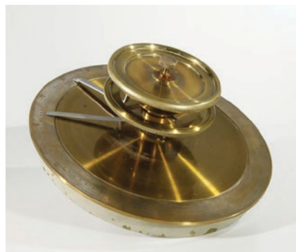
Abbildung 2: Webersche Rechenscheibe mit fester Grundplatte, drehbarem Ring und drehbarer Scheibe (© ETH-Bibliothek Zürich)
