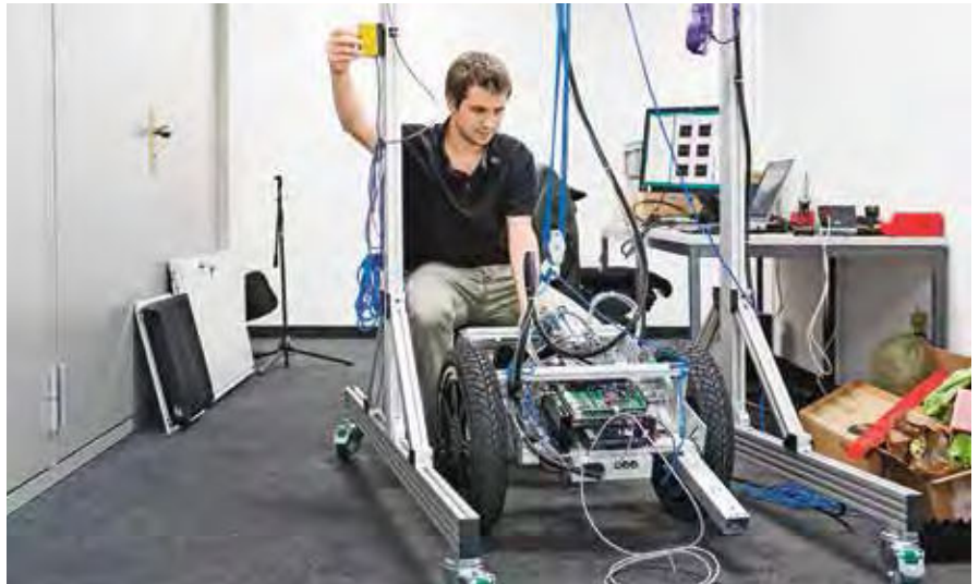
Im Projekt «Scalevo» entwickeln Studierende einen treppengängigen Rollstuhl. Ein entscheidendes Element ist die Balanceregulation des Gefährts.
