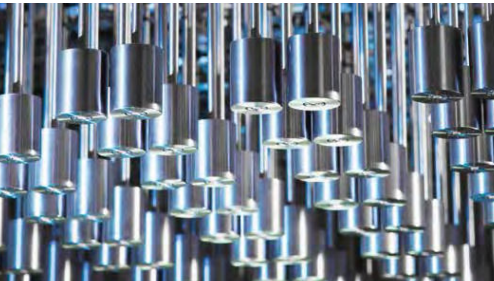
Dieses Modell besteht aus 270 Pendeln, die über Federn miteinander verbunden sind. Die Pendel verhalten sich nach dem quantenmechanischen Prinzip des topologischen Isolators.
