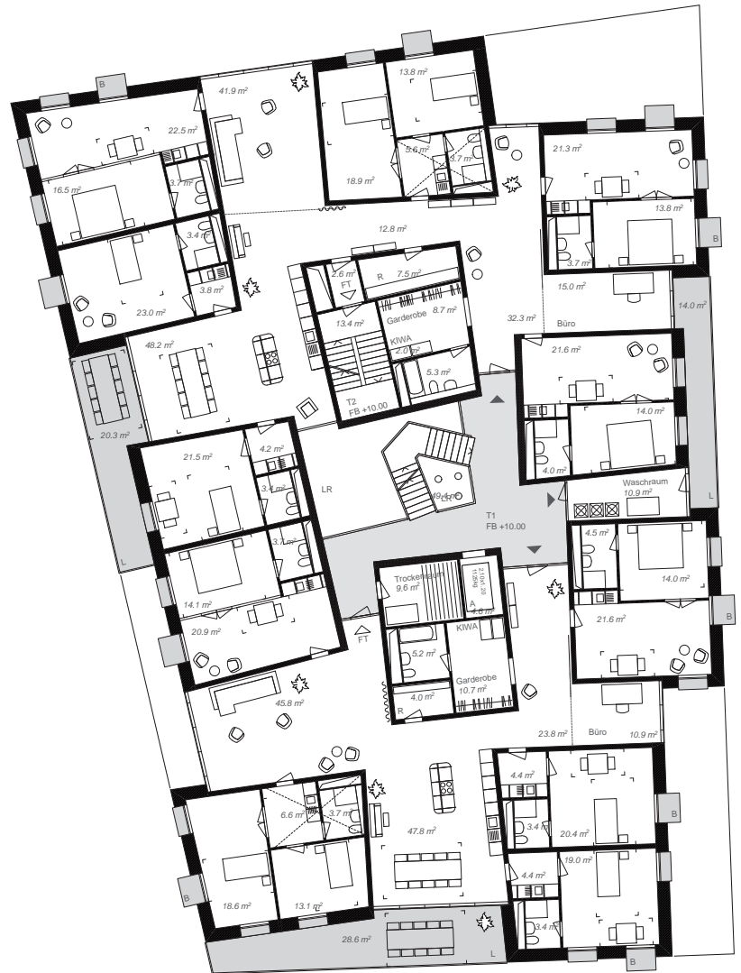
Figure 6-2 : Programmes innovants de construction de logements : appartements satellites pour personnes seules dans le projet «Mehr als Wohnen», terrain Hunziker, Zurich-Leutschenbach
