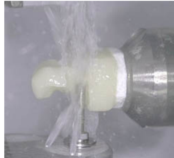
Bild 2: Formschleifen eines Zahnersatzes aus einem Keramikblock [1]
