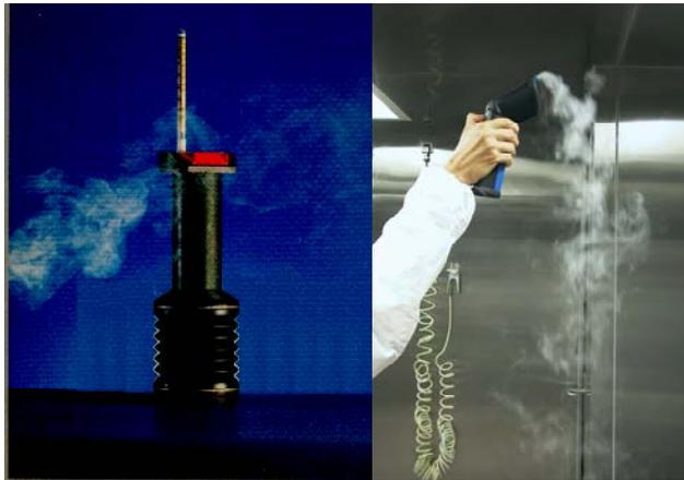
Abb. 4-5: Rauchröhrchen zur qualitativen Darstellung der Turbulenz von Luftströmungen.
