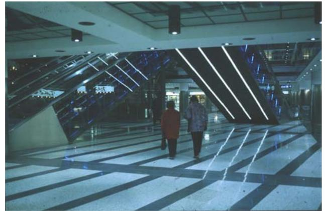
Abb. 1-7: Hauptbahnhof Zürich: Durch verwirrende Linien-Strukturen werden Sehbehinderte dazu geleitet, nach rechts zu gehen und in die Schaufenster zu stossen.
