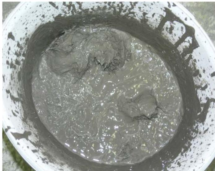
Aus den Vorversuchen konnten folgende maximale Faseranteile festgestellt werden: für 24 mm Fasern 0.8%, für 12 mm Fasern 2% und für 3 mm Fasern 6%. Diese dienten als Grundlage für die Mischungen der Hauptversuche.
