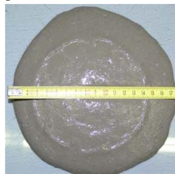
Der Schaum wurde mit dem Membran-Schaumgenerator hergestellt mit einer Proteinkonzentration von 50 g/l und einer Zielschaumdichte von 80 g/l. Bei der Herstellung des Schaums musste darauf geachtet werden, dass man den Generator etwa 10 s vor bzw. nach der Entnahme laufen liess, um den Schaum für die Mischung zu entnehmen, da der generierte Schaum am Anfang bzw. am Schluss der Herstellung durch den Start- bzw. Endprozess nicht die der Einstellung entsprechenden Dichte aufweist.
