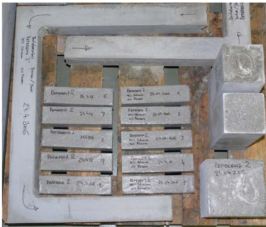
Die Würfel, welche für die Wärmedurchgangsmessungen verwendet wurden, lagerten vor der Messung mindestens eine Woche im Raum der Wärmedurchgangsprüfung, um die Proben zu akklimatisieren. In diesem Raum herrscht ein Klima von 20°C und ca. 40% relativer Luftfeuchte vor.
