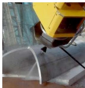
Abb. 3.4 Wasserstrahlroboter mit 3 Freiheitsgraden für die computergesteuerte Durchführung von komplexen Schnitten [55]
