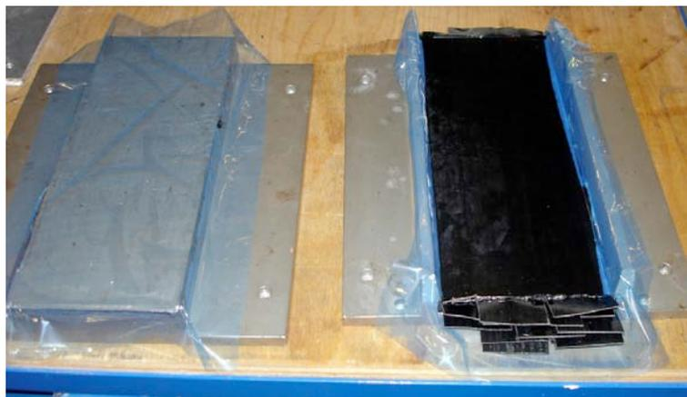
Abb. 4.5 Presswerkzeug mit fertig gepresster Platte in der unteren Formhälfte (r)
