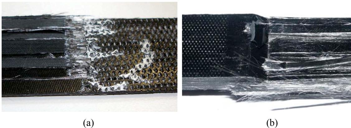
Abb. 6.6 Durchgehende Plytron 0° Probe, ohne Endplatten (a) und Referenzprobe mit dickeren Enden (b), jeweils nach Zugtest, im Übergang zum Einspannbereich
