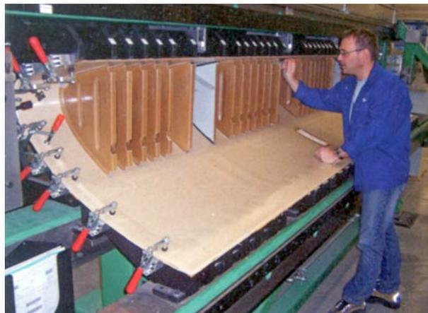
Abb. 2.8 Widerstandsgeschweisster Abschnitt aus der J-Nose einer Airbus gefertigt bei Stork Fokker in Holland [9]
