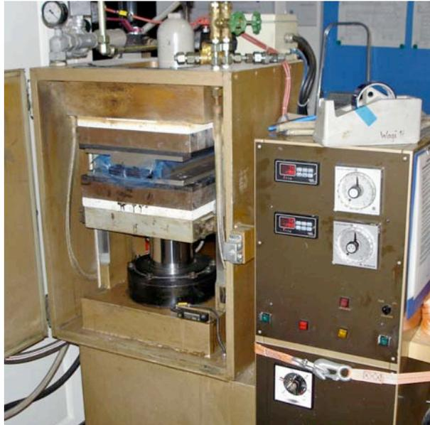
Abb. 4.4 Fontijne Heisspresse mit eingelegtem Presswerkzeug
