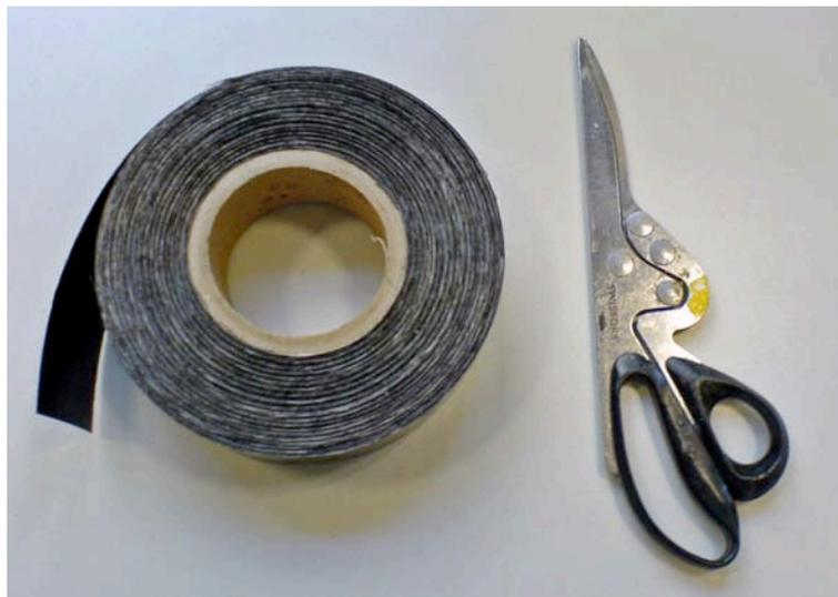
Abb. 4.1 Bandförmiges Plytron Halbzeug und Schere
