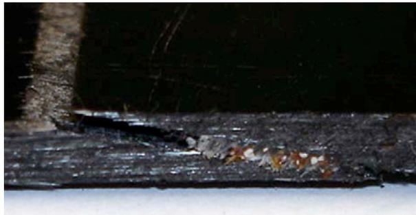
Abb. 4.12 Geschäftete Probe verschweisst mit dem EMABond<sup>®</sup> Verfahren
