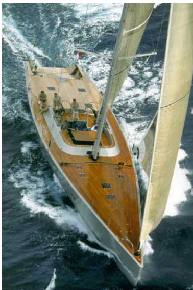
Bild (B024fueZ) Verklebtes Teakholz-Deck (Sika)
