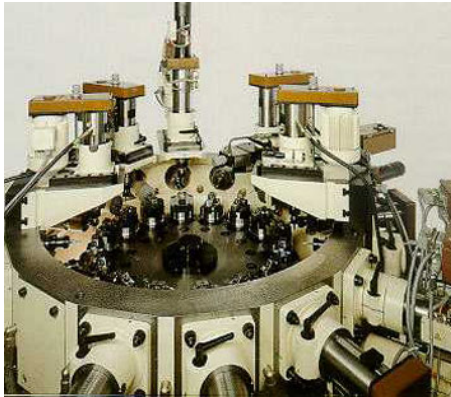
Bild (B051treZ) Transfer-Bearbeitungszentrum, Das Bauteil wird von Station zu Station gedreht und die verschiedenen Bearbeitungsoperationen parallel durchgeführt (Hug)
