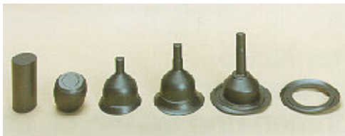
Bild (B006umfZ) Achszapfen gesenkgeformt (Eumuco)
