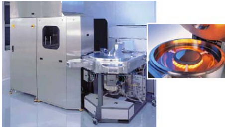
Bild (B010besZ) CVD-Anlage, Blick in Vakuumkammer (Aixtron)
