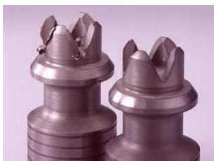
Bild (B113treZ) spanend bearbeitetes Bauteil vor und nach der Behandlung mit TEM (Moser Entgratung)
