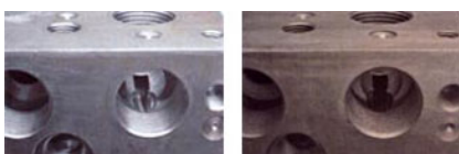
Bild (B111treZ) TEM-behandelte Werkstücke weisen einen Niederschlag auf, welcher von den verdampften Gräten herrührt (Moser Entgratung)
