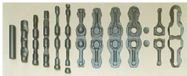
Bild (B013umfZ) Vom Stangenabschnitt zum Pleuel: Reckwalzen, Gesenkformen, Lochen, Entgraten (SMS Eumuco)
