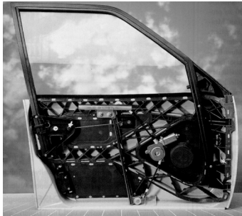
Bild (B002fueZ) Hybridtechnik im Automobilbau (Türbau mit Stahlblechaussenhaut und geripptem Kunststoffinnenteil)
