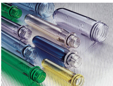
Bild (B073urfZ) Preforms für PET-Flaschen (Netstal)
