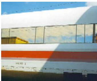
Bild (B025fueZ) Geklebte Scheiben und Verkleidungen bei Fahrzeugen (Sika)
