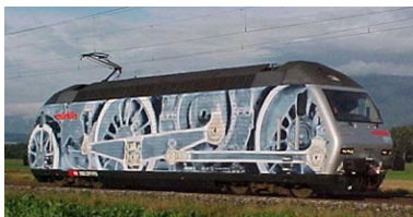
Bild (B071umfZ) Die Seitenwände der RE 4/4 460 sind mit Sicken verstärkt ( Modellbahn.com )
