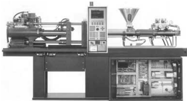
Bild (B066urfZ) kleine Spritzgussmaschine mit Schliesseinheit (links), Schneckenkolben (rechts) und Steuerung (mitte, unten) (Demag Ergotech GmbH)
