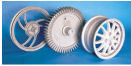
Bild (B022urfZ) Räder für jeden Zweck werden gegossen. (Kurtz)
