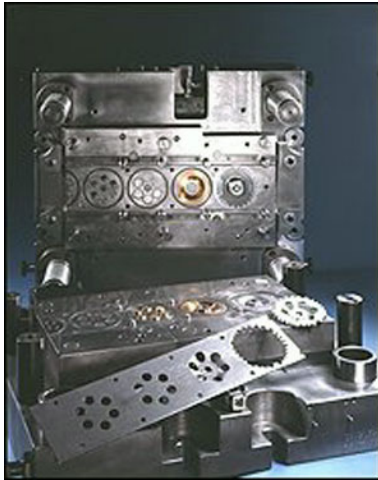
Bild (B057umfZ) Folgeschnittwerkzeug und Blechabschnitt (Quelle: Feintool)
