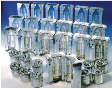
Bild (B080urfZ) Blasformen sind typischerweise dreiteilig: Boden und 2 Formhälften (Röders)
