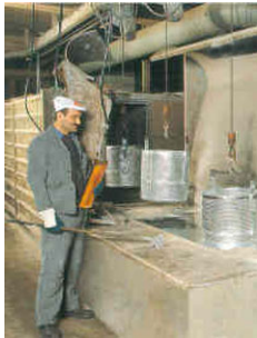
Bild (B003besZ) Kleinteile werden als Schüttgut in einem Behälter verzinkt. (Verzinkerei Wollerau)
