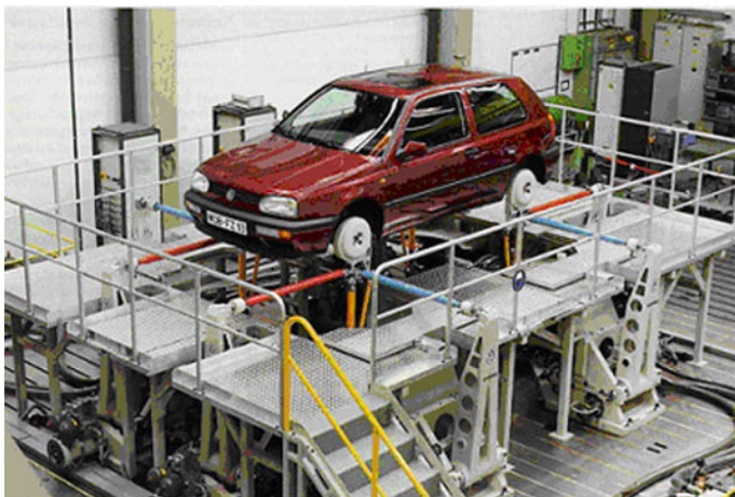
Bild (B601werZ) PKW im Dauerversuch (Quelle: Schenck AG, BRD)
