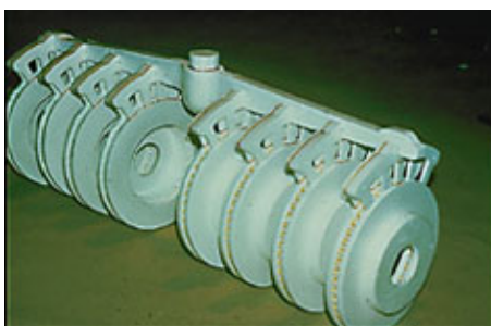
Bild (B008urfz) Schaumstoffmodell für innenbelüftete Bremsscheiben (Kurtz)
