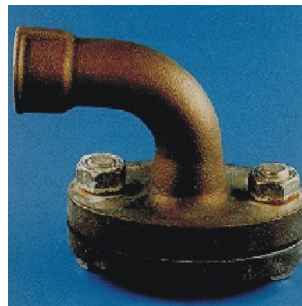
Bild (B017werZ) Beispiel einer Kontaktkorrosion zwischen dem edleren, kathodischen Material (Bronze-Flansch) und dem unedleren anodischen Material (verzinkte Schrauben) (Bosshard)
