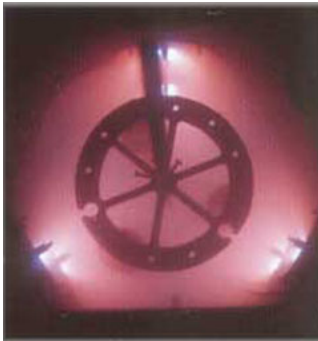
Bild (B009besZ) PVD-Anlage, Blick in eine Vakuumkammer (ZOM Oberflächenbearbeitungs-GmbH)
