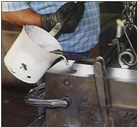
Bild (B009urfZ) Flüssiges Metall wird in die Kokille gegossen. (R. Frei AG)
