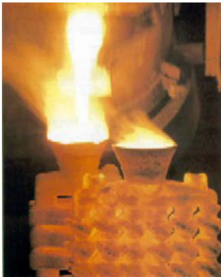
Bild (B006urfZ) Die Formschalen mit flüssigem Metall gefüllt (Giesserei Hegi AG)
