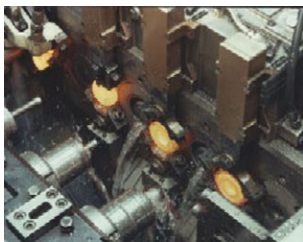
Bild (B014umfZ) Blick in eine Gesenkformmaschine mit mehreren Umformstationen (Hatebur)
