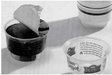
Bild (B926werZ) Beispiel Joghurt-Becher: steif (bei minimaler Dicke), transparent, sterilisierbar, bedruckbar, geschmacksneutral
