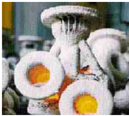
Bild (B019urfZ) Erstarren eines Feigussteiles (Otto Kälin)
