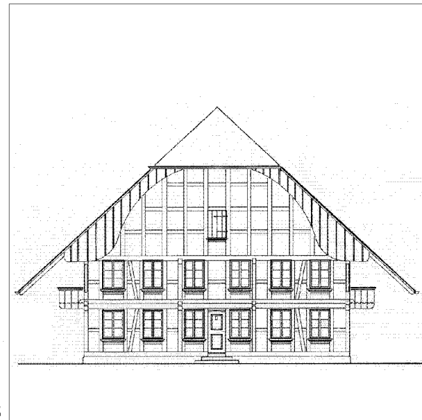
Abb. 15 Der Riegelbau aus der Region Bern, Berner Ründidach (0137)
