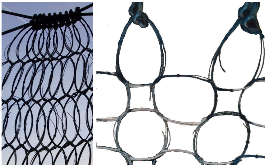
Abbildung 3.4: Belastung und Verformungsfiguren zu Zwei-, Drei- und Vierecken der Netzringe bei ein- und zweiachsiger Beanspruchung
