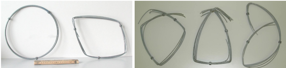
Abbildung 3.6: Darstellung der Biegeverformung: (links) Unbelasteter und zu einem Viereck verformter Ring und (rechts) drei verformte und anschliessend an verschiedenen Stellen durchtrennte Netze (Ringe 1 und 2 waren jeweils zu einem Viereck und Ring 3 zu einem Zweieck verformt)
