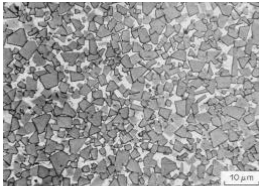
Bild 3-20: Wolframcarbidkörner in einer Kobaltmatrix [1].
