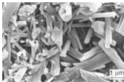
Bild 3-16: Geätzte Bruchfläche eines Bauteils aus SSN [2].
