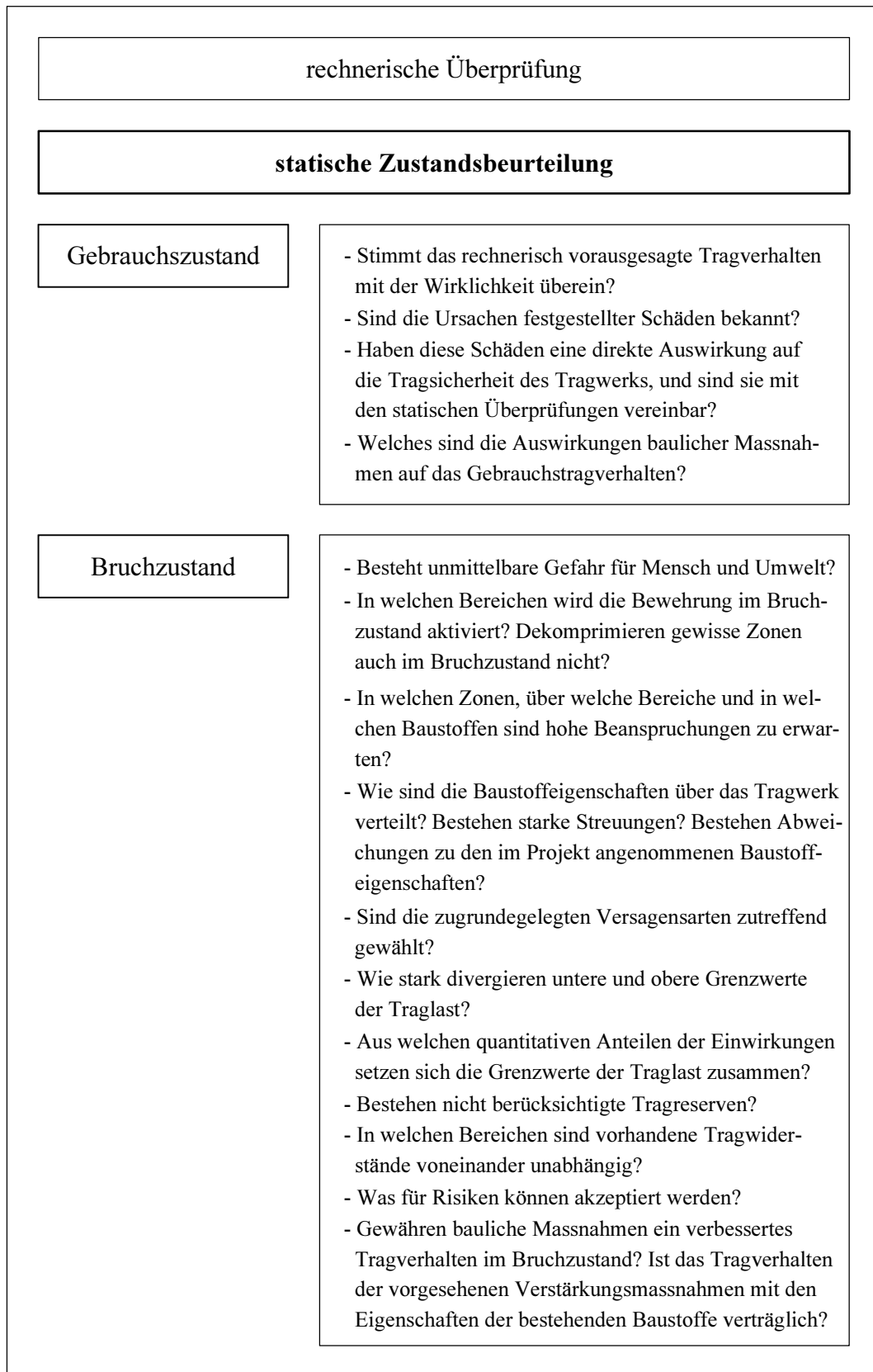
Bild 4.2 – Fragenkatalog zur statischen Zustandsbeurteilung bestehender Stahlbetonbauten.
