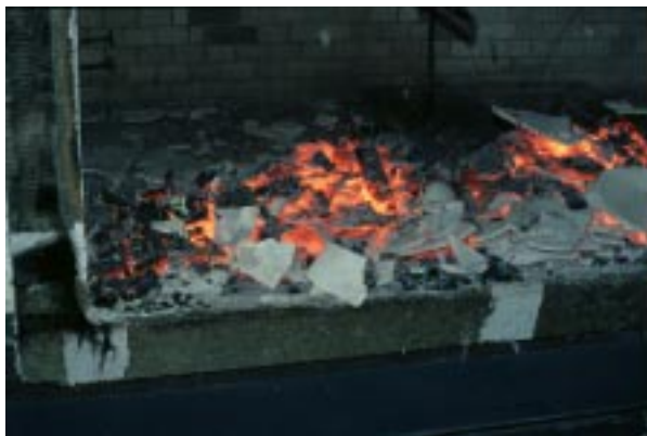
Abbildung D77 Restteile der Wand 3 im Vertikalofen nach dem Brandversuch
