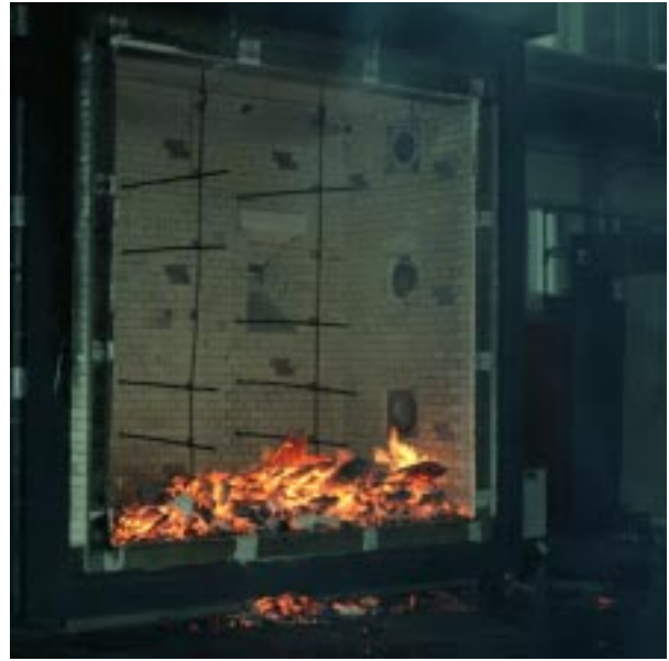
Abbildung D74 Restteile der Wand 3 im Vertikalofen nach dem Brandversuch
