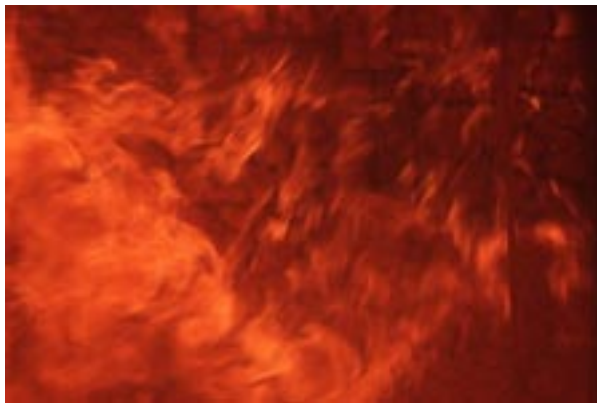
Abbildung D9 Foto Nr. 10 nach 36 Min.: Dreischichtplatte (1) weitgehend weggebrannt
