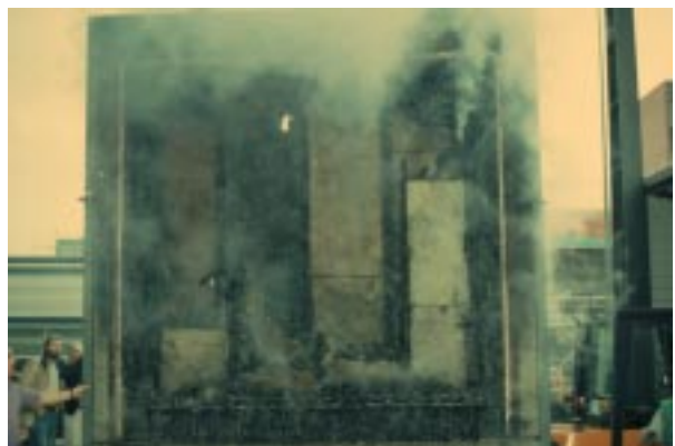
Abbildung D54 Wand 2 nach dem Brandversuch
