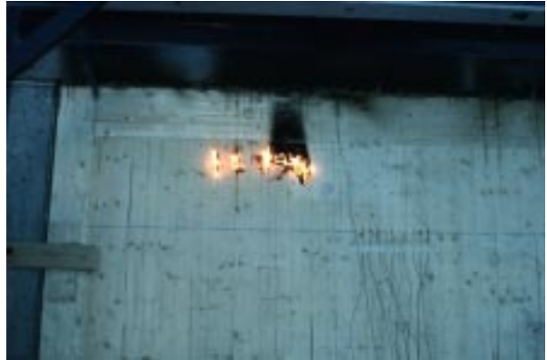
Abbildung D20 Foto Nr. 23 nach 76 Min.: Durchbrand durch Dreischichtplatte (5)
