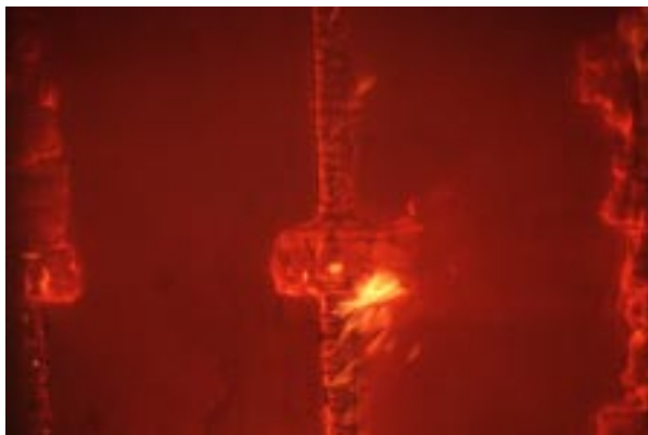
Abbildung D35 Foto Nr. 9 nach 38 Min.: Steinwolle (2) links/Mitte links dem Feuer direkt ausgesetzt
