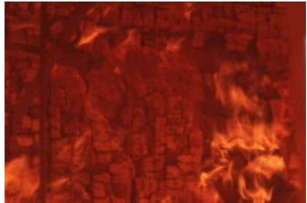
Abbildung D86 Foto Nr. 6 nach 35 Min.: Dreischichtplatte (1) Mitte oben weggebrannt
