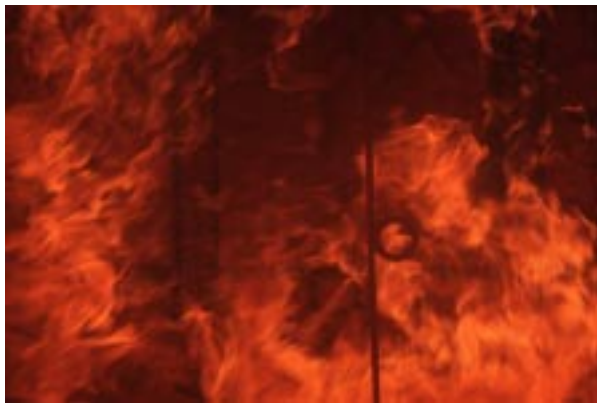
Abbildung D87 Foto Nr. 7 nach 40 Min.: Pavathermplatte (2) Mitte links / links dem Feuer direkt ausgesetzt
