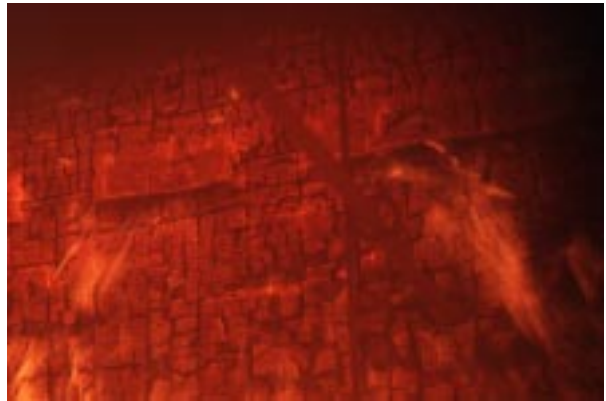
Abbildung D32 Foto Nr. 6 nach 28 Min.: 2. Stück von ca. 10 cm von Abdeckbrett Mitte abgefallen
