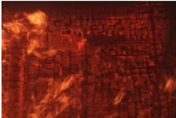
Abbildung D85 Foto Nr. 5 nach 31 Min.: Weitere Stücke des Abdeckbrettes abgefallen
