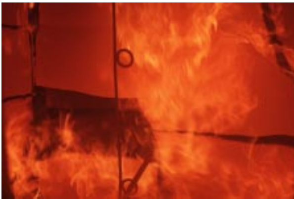
Abbildung D63 Foto Nr. 8 nach 40 Min.: Stücke Fermacellplatte (1) rechts fallen ab
