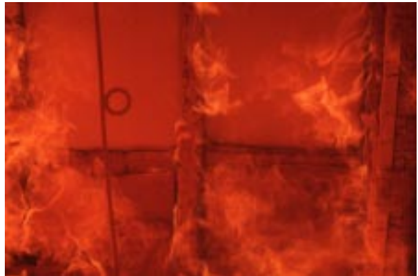
Abbildung D70 Foto Nr. 15 nach 65 Min.: Fermacellplatte (5) Mitte rechts / rechts dem Feuer direkt ausgesetzt
