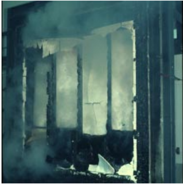
Abbildung D73 Wand 3 nach dem Brandversuch
