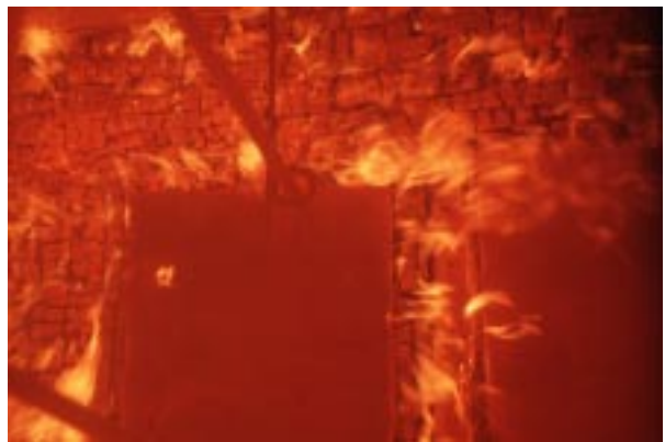
Abbildung D48 Foto Nr. 24 nach 78 Min.: Steinwolle (6) rechts/Mitte rechts dem Feuer direkt ausgesetzt
