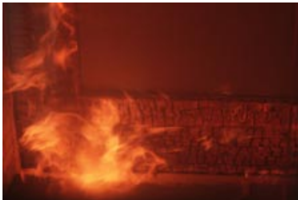
Abbildung D59 Foto Nr. 4 nach 21 Min.: Ecke unten links vom BSH- Rahmenträger verkohlt
