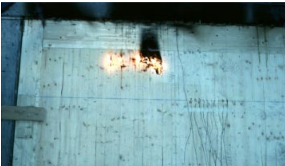
Abbildung 12 Durchbrand durch die Wand 1 nach 76 Minuten
