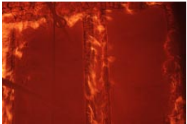
Abbildung D46 Foto Nr. 22 nach 74 Min.: Steinwolle (6) rechts/Mitte rechts dem Feuer direkt ausgesetzt
