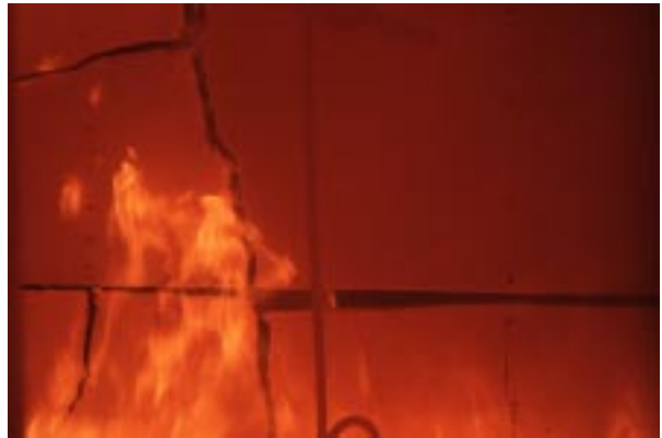
Abbildung D100 Foto Nr. 21 nach 92 Min.: Viele Risse in Fermacellplatte (5)
