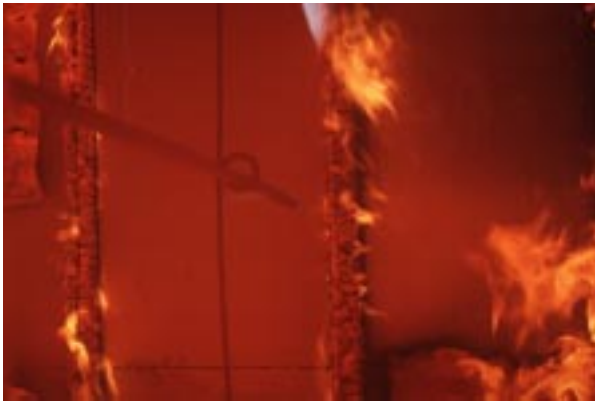
Abbildung D91 Foto Nr. 11 nach 54 Min.: Fermacellplatte (3) rechts dem Feuer direkt ausgesetzt
