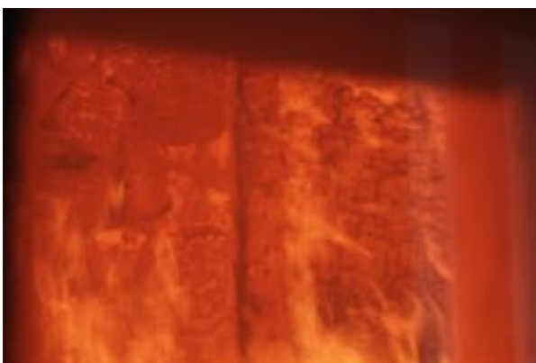
Abbildung D17 Foto Nr. 20 nach 66 Min.: Pavathermplatte (4) abgefallen
