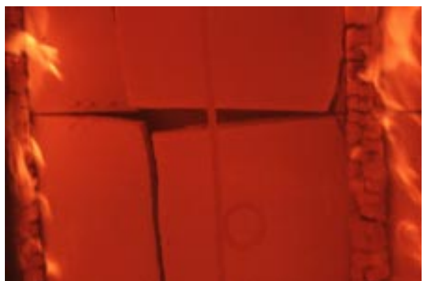
Abbildung D96 Foto Nr. 16 nach 67 Min.: Fermacellplatte (3) öffnet sich
