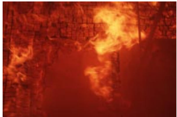
Abbildung D40 Foto Nr. 15 nach 52 Min.: Steinwolle (2) oben links scheint zu „schmelzen“
