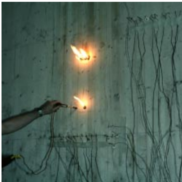
Abbildung D105 Foto Nr. 26 nach 113 Min.: Durchbrand durch Dreischichtplatte (7)
