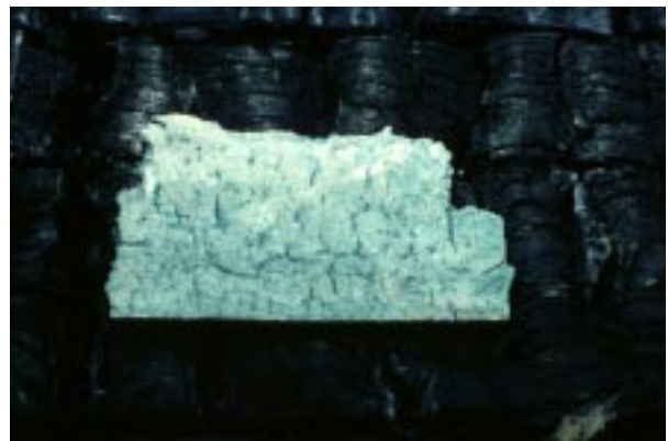
Abbildung D78 Restteile der Fermacellplatte nach dem Brandversuch
