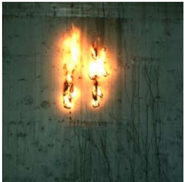
Abbildung D106 Foto Nr. 27 nach 113 Min.: Durchbrand durch Dreischichtplatte (7)
