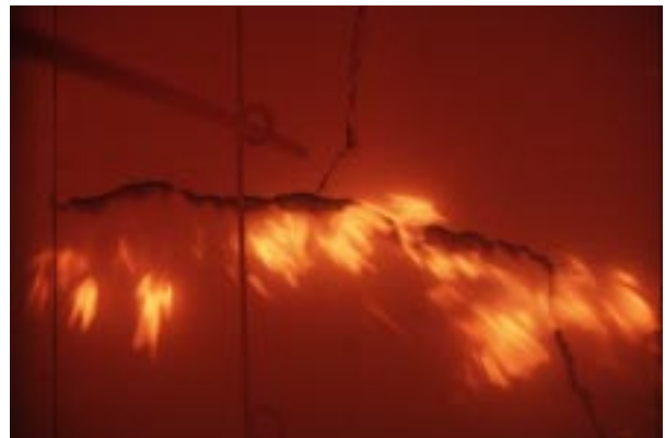
Abbildung D60 Foto Nr. 5 nach 27 Min.: 2. Riss in Fermacellplatte (1) ganz rechts
