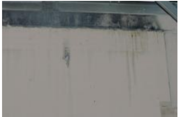
Abbildung D50 Foto Nr. 26 nach 80 28 Min.: Durchbrand durch Dreischichtplatte (7)
