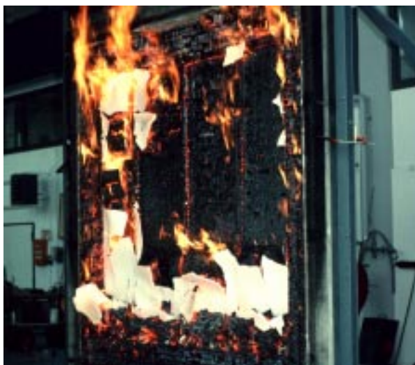
Abbildung D107 Wand 4 nach dem Brandversuch
