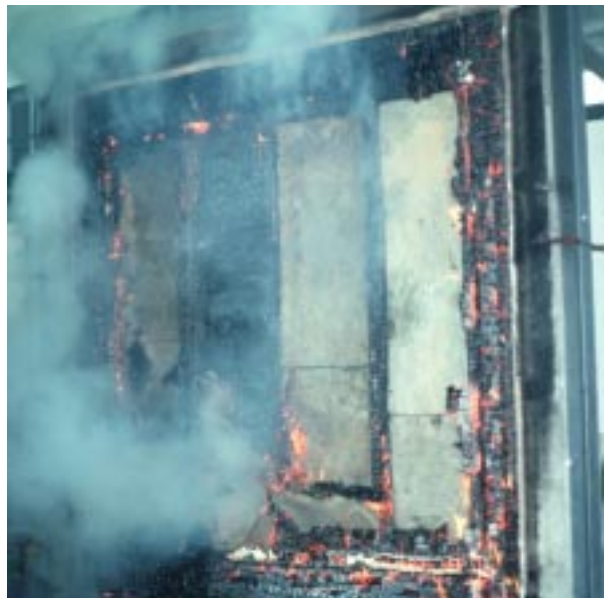
Abbildung D52 Wand 2 nach dem Brandversuch
