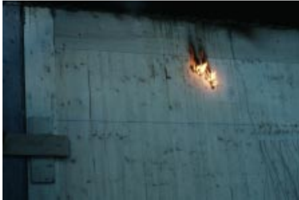
Abbildung D19 Foto Nr. 22 nach 76 Min.: Durchbrand durch Dreischichtplatte (5)
