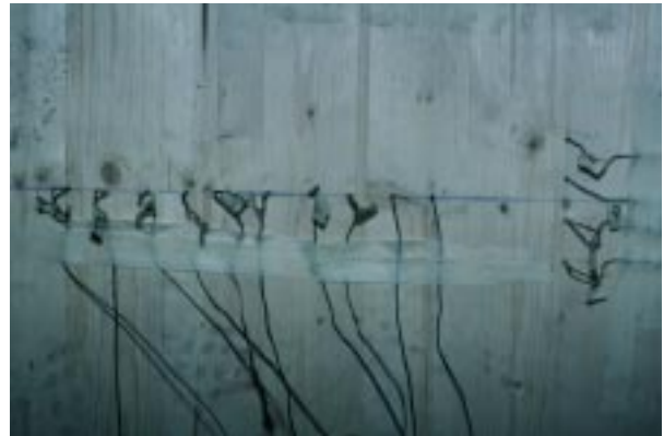
Abbildung D80 Thermoelemente der Gruppen B (T11 bis T20) und D (T31 bis T34)
