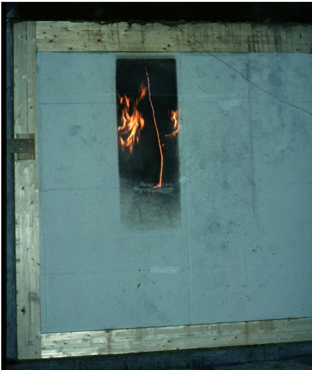
Abbildung 29 Durchbrand durch die Wand 3 nach 71 Minuten
