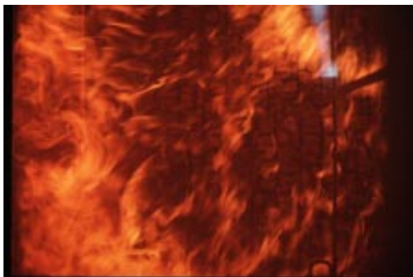
Abbildung D5 Foto Nr. 4 nach 28 Min.: Holzkohle der Dreischichtplatte (1) beinahe noch komplett
