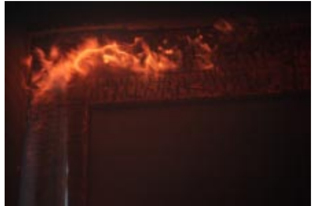
Abbildung D58 Foto Nr. 3 nach 15 Min.: Ecke oben links vom BSH- Rahmenträger verkohlt
