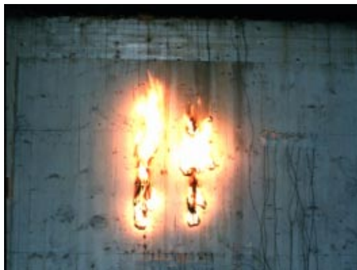
Abbildung 37 Durchbrand durch die Wand 4 nach 113 Minuten
