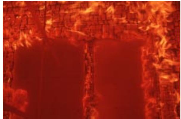
Abbildung D38 Foto Nr. 12 nach 45 15 Min.: Steinwolle (2) rechts/Mitte rechts dem Feuer direkt ausgesetzt
