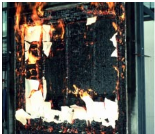
Abbildung D108 Wand 4 nach dem Brandversuch
