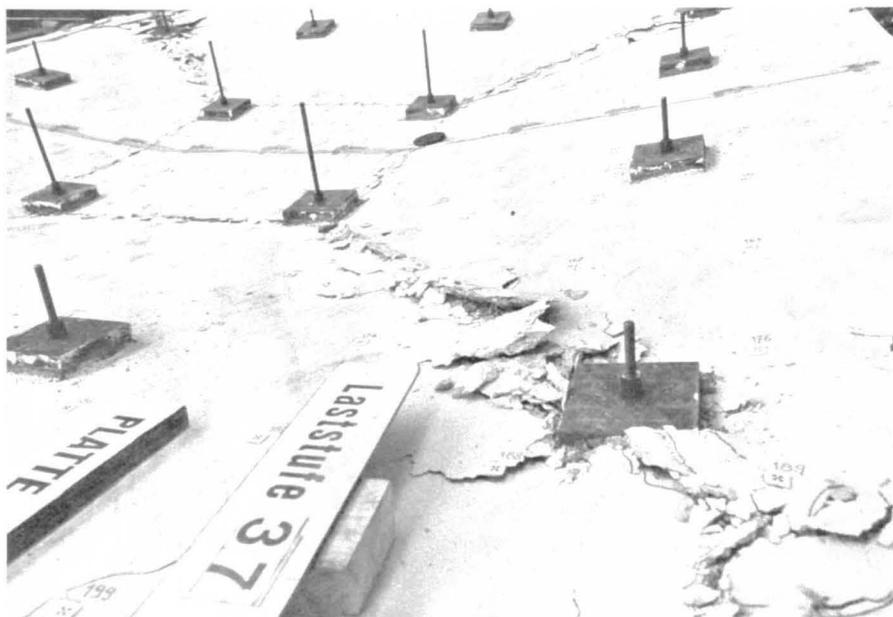
Bild 29: Bruchmechanismus Platte P1 (Oberseite)
