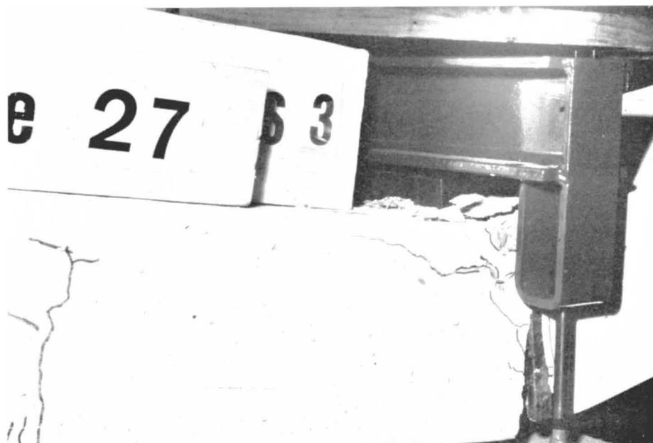
Bild 83: Detail Gelenk Plattenstreifen PS 3
