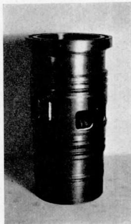
Abb. 52. Zylinderbüchse mit erweiterten Schlitzen für Rohrleitungen von 60 mm Durchmesser, rechts Spülseite, links Auspuffseite.
