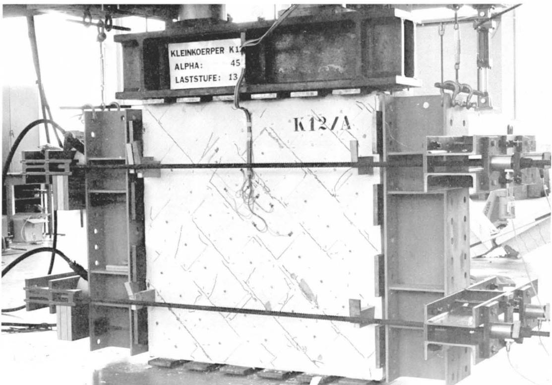
Bild 7 : Versuchsanlage für zweiachsige Druck - Belastung
