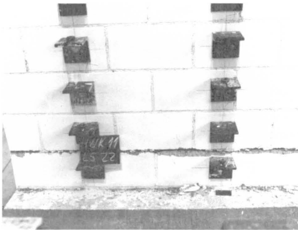
a) stärkere Steinabsplitterungen (kein Bruch)
