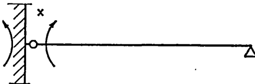
Abb. 3.3 Grundsystem mit überzähliger Größe X
