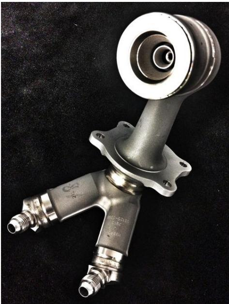
Abbildung 2: Einspritzdüse der neuen LEAP-Turbine von GE (GE Reports, 2014)
