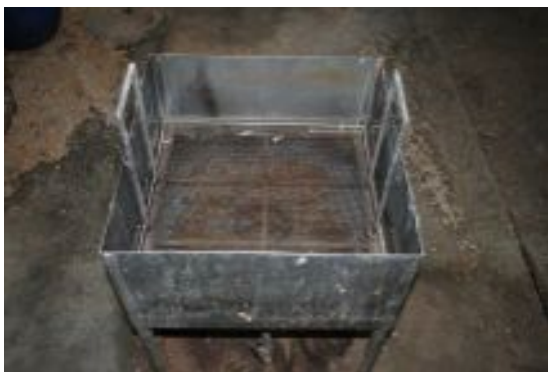
Abbildung 2.5: Entwässerungskasten für Stoffsuspension (links), Laborpresse (rechts) im Technikum Pavatex S.A.
