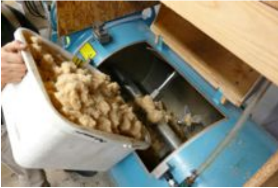
Abbildung 3.6: Faserstoffbeleimung im Trommelmischer (links); Formkasten für Plattendurchströmung (rechts) am IHD
