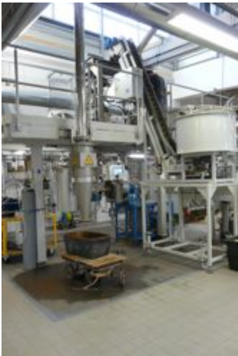
Abbildung 3.2: Laborrefineranlage IHD (links); Detailansicht Kocher mit Sichtfenstern (rechts)
