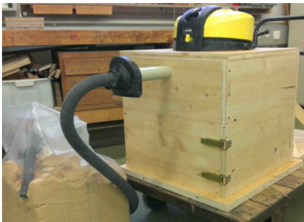
Abbildung 3.7: Einrichtung zur Prüfkörperherstellung ohne Bindemittel (links); Faserstoffkuchen vor der Verdichtung (rechts)
