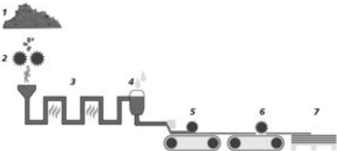
Abbildung 2.11: Holzfaserdämmstoffherstellung auf speziellen Trockenanlagen. Schematische Darstellung (Pavatex 2012). (1) Rohmaterial (Hackgut), (2) Zerfaserung, (3) Faserstofftrocknung, (4) Faserstoffbeleimung, (5) Vliesbildung, (6) Aushärtung, (7) Endbearbeitung (Zuschnitt, Profilierung) und Verpackung
