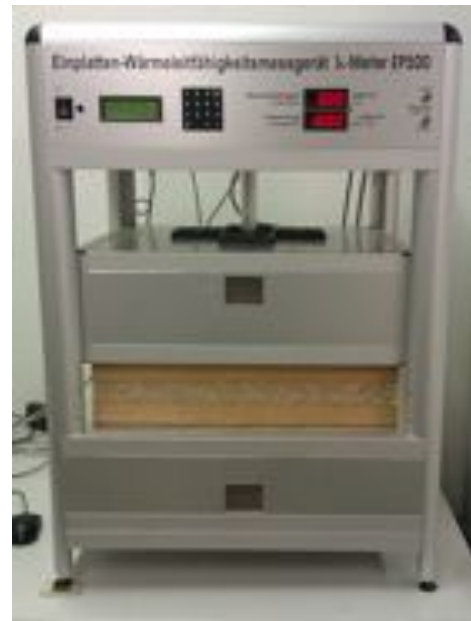
Abbildung 3.18: effektive Messfläche des Prüfgerätes (Lambda-Messtechnik 2006) (links), Wärmeleitfähigkeitsmessgerät mit eingebauter Probe (rechts).
