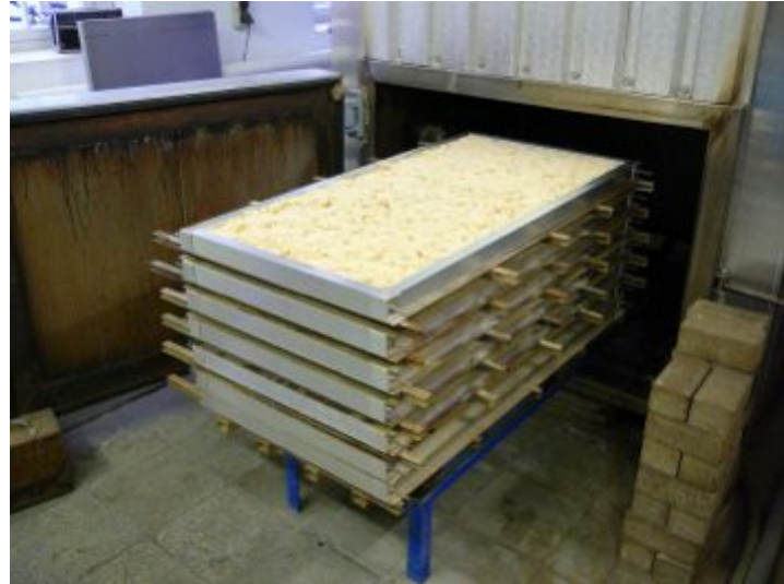
Abbildung 3.3: Thermokammer mit Beschickungsmaterial (links); Holzfaserstoff vor der Beschickung in die Thermokammer. Ohne obere Abdeckung (rechts) (Scheidung 2014)
