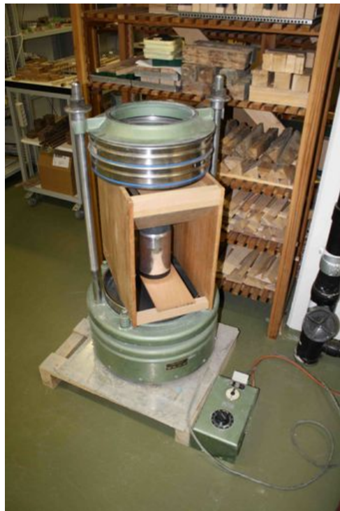
Abbildung 3.10: Schwingesieb mit Schüttkasten und Messzylinder für die Schüttdichtemessung
