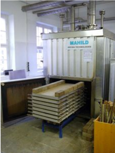
Abbildung 3.3: Thermokammer mit Beschickungsmaterial (links); Holzfaserstoff vor der Beschickung in die Thermokammer. Ohne obere Abdeckung (rechts) (Scheidung 2014)
