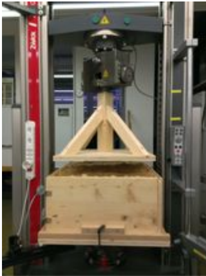
Abbildung 3.8: Einrichtung zur Plattenformung ohne Bindemittel (links); Faserstoff mit Druckstempel und halb geöffneten Formkasten (rechts)
