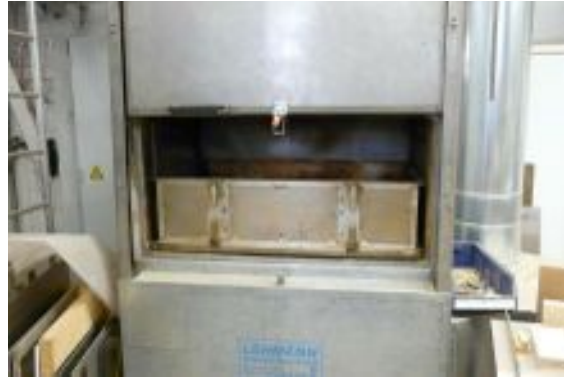
Abbildung 3.6: Faserstoffbeleimung im Trommelmischer (links); Formkasten für Plattendurchströmung (rechts) am IHD
