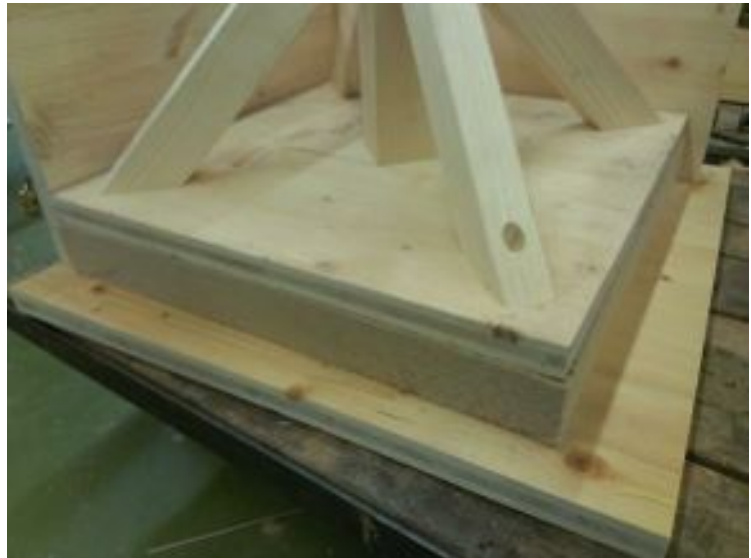
Abbildung 3.8: Einrichtung zur Plattenformung ohne Bindemittel (links); Faserstoff mit Druckstempel und halb geöffneten Formkasten (rechts)
