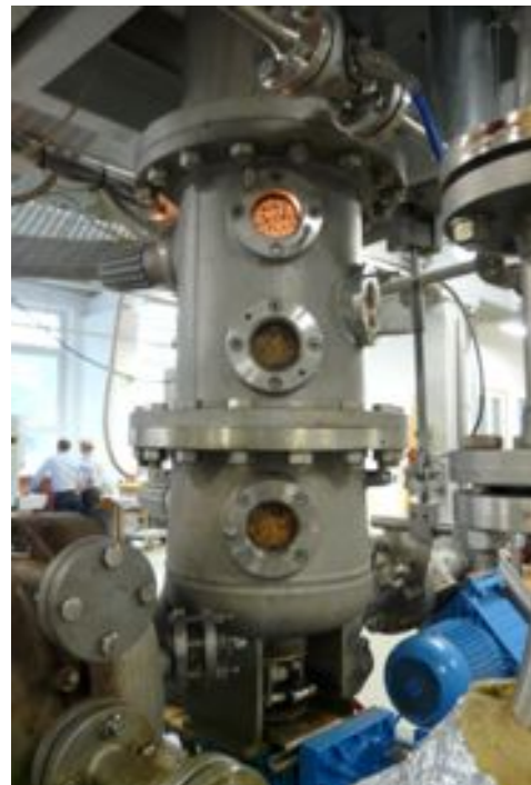
Abbildung 3.2: Laborrefineranlage IHD (links); Detailansicht Kocher mit Sichtfenstern (rechts)
