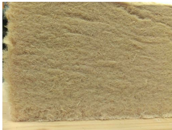
Abbildung 3.7: Einrichtung zur Prüfkörperherstellung ohne Bindemittel (links); Faserstoffkuchen vor der Verdichtung (rechts)
