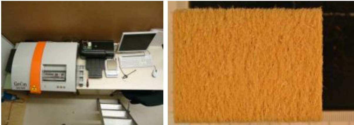
Abbildung 3.11: Labor-Rohdichteprofilmessgerät Grecon DAX 5000 (links); Probenkörper (rechts)
