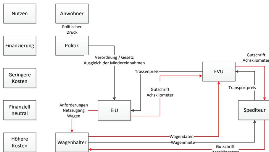
Abbildung 10: Beziehungen im System Bahn bei einer Kompensation über den Trassenpreis (eigene Darstellung)
