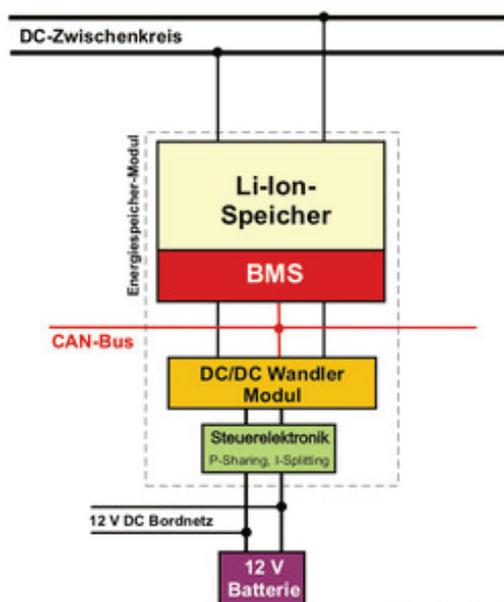
Abbildung 19: Speicherintegration in den DC-Zwischenkreis (Abbildung: Hörmann Engineering)
