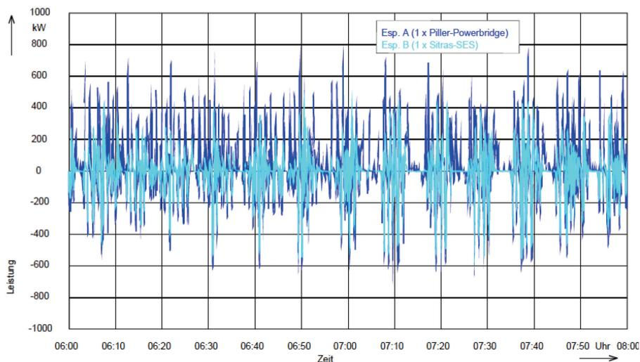
Abbildung 16: Typischer Lastgang einer DC-Stadtbahnanwendung mit Taktverkehr [23]
