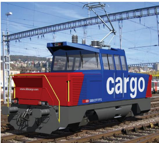
Abbildung 20: Zweikraftlokomotive Eem 923 der SBB Cargo (Grafik: Stadler Rail)
