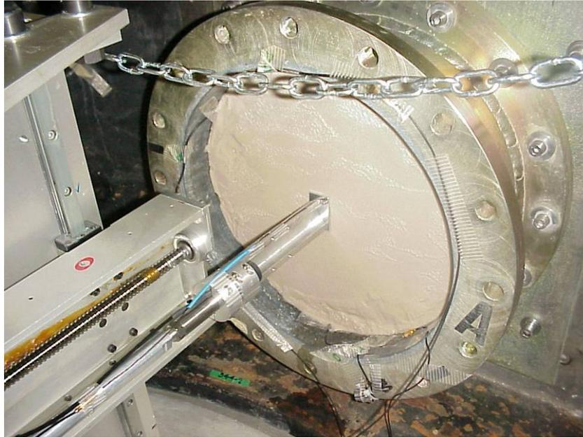
Abb. 4.20: Rutsche, welche die Kugel führt, die auf der Platte auftrifft.
