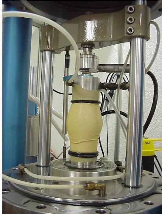
Abb. 4.7: Triaxialversuche an trockenem Perth-Sand
