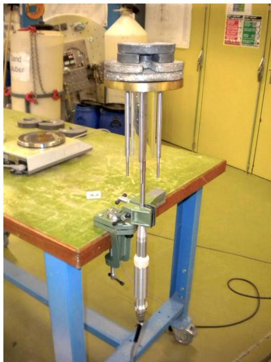
Abb. 4.33: Kalibration des CPT-Gerätes
