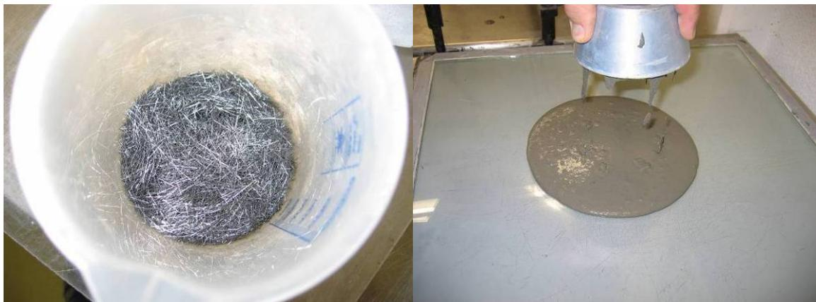
Abb. 4.38: Links: Verwendete Stahlfasern. Rechts: Ausbreitmass
