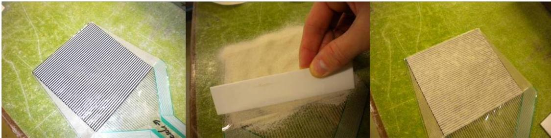
Abb. 7.76: Beschichtungsvorgang der Tekscan-Folie: Links: Folie vor Beschichtung; Mitte: Perth-Sand wird auf das doppelseitige Klebeband aufgebracht und abgezogen; Rechts: Fertig beschichtete Folie
