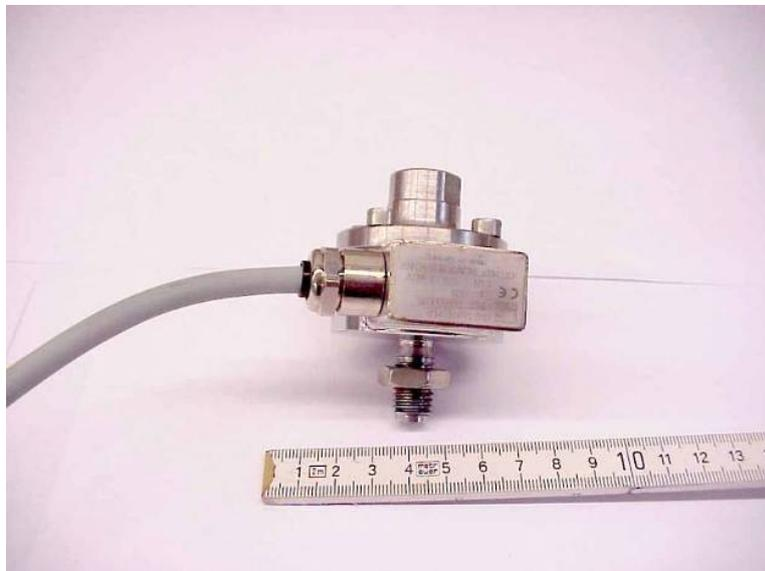
*Abb. 4.14: Lastzelle des Herstellers HBM*
