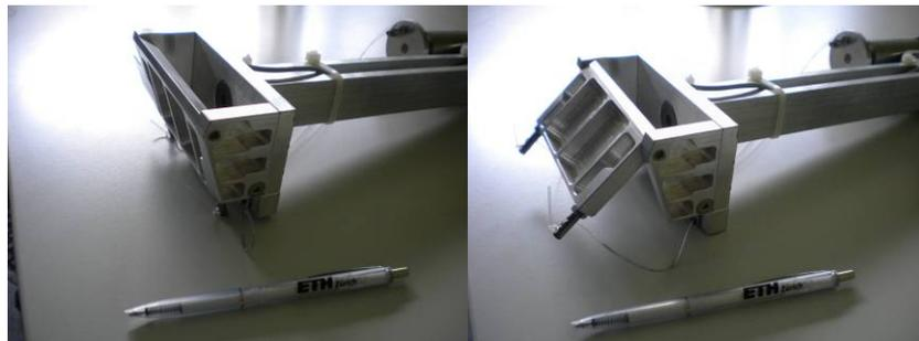
*Abb. 4.29: Grosses Baggertool links mit geschlossener Schaufel; rechts mit geöffneter Schaufel und sichtbarer Seilzugvorrichtung*
