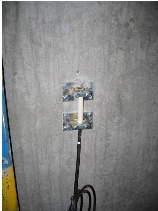
*Abb. 5.11: Deformationsaufnehmer, der die Stützenstauchung misst. Auf beiden Seiten der Stütze ist je ein Aufnehmer angelegt.*
