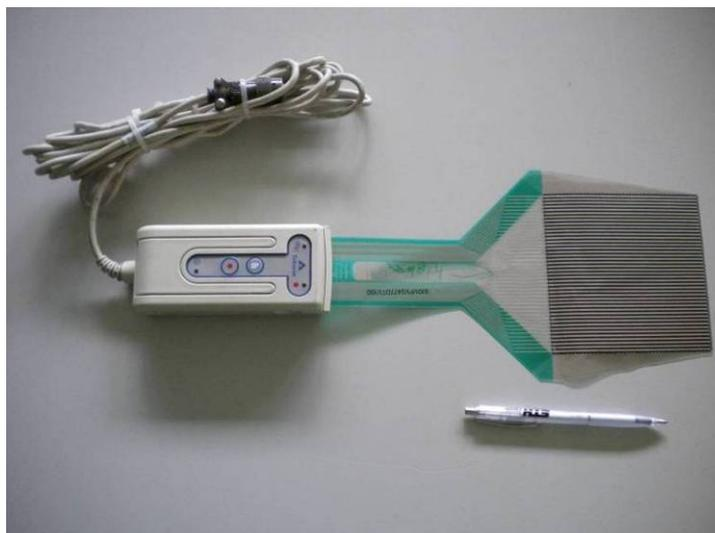
Abb. 4.11: Tekscan-Messsystem mit Folie; Handle und Kabelverbindung
