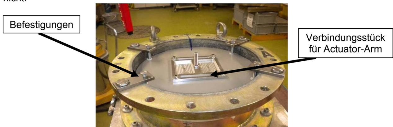
Abb. 7.9: Deckel mit Actuator-Verbindung und Befestigungen für den Transport in die Zentrifugentrommel
