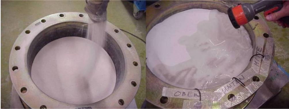
Abb. 4.34: Links: Einrieseln des Perth-Sandes in die Strongbox aus einer Höhe von 30 cm. Rechts: Wässern des Bodenmodells, welches mit einem Filter-Papier als Erosionsschutz abgedeckt ist, für die Erzeugung der Saugspannungen.
