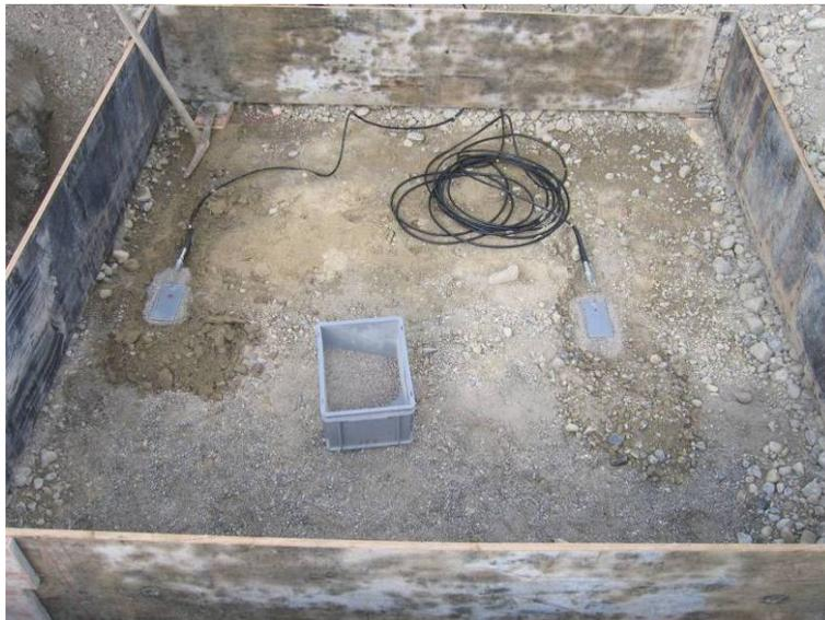
Abb. 5.15: Einbau und Positionierung der Druckkissen in Merenschwand
