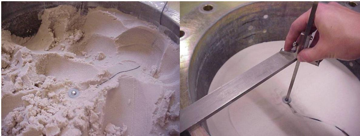
Abb. 4.21: Links: Beschleunigungsaufnehmer mit Plättchen zur korrekten Positionierung beim Ausbau. Rechts: Einbau und Positionsbestimmung der Beschleunigungsgeber mit Schublehre
