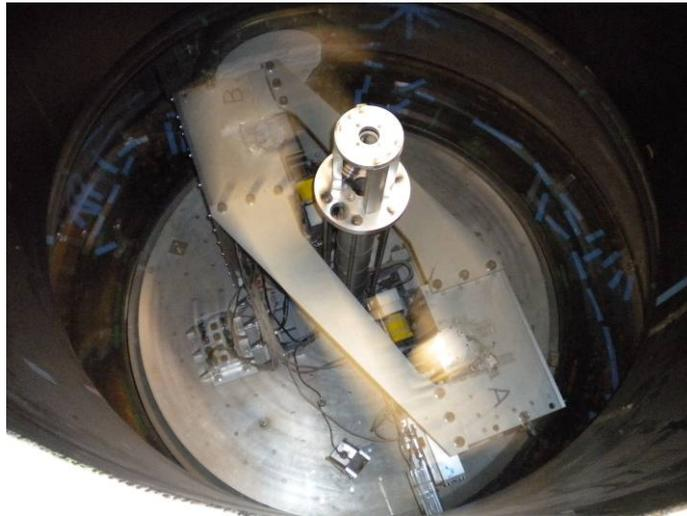
Abb. 4.1: Die Trommelzentrifuge des Instituts für Geotechnik der ETH Zürich. Blick von oben in die sich drehende Zentrifuge
