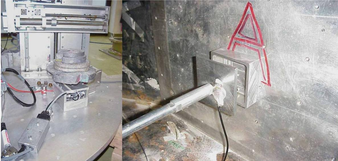
Abb. 4.17: Links: Kalibrierungstest durch Auflegen von Gewichten; rechts: Eichtest durch Belastung mit dem Actuator-Arm
