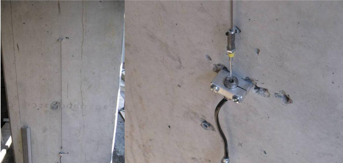
Abb. 5.16: Links: Wegaufnehmer zur Messung der Stützenstauchung. Rechts: Detailansicht der Spule, welche je nach Standort des Magneten an der Stange, der sich innerhalb der Spule befindet, einen anderen Widerstand ausgibt und damit die Stützenstauchung erfasst.
