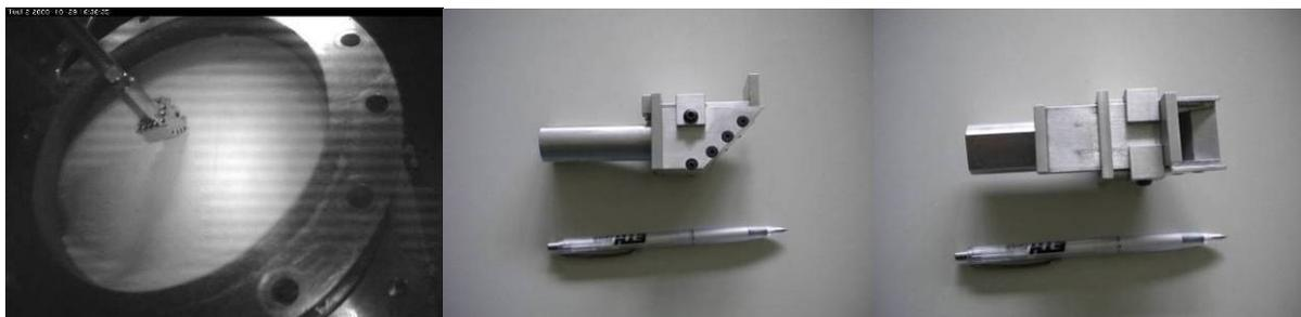
Abb. 4.27: Links: Kleines Bagger-Werkzeug bei der Probenentnahme „inflight“. Mitte: Schaufel des kleinen Baggers von der Seite mit geschlossener Öffnung. Rechts: Schaufel des kleinen Baggers von oben mit offener Öffnung
