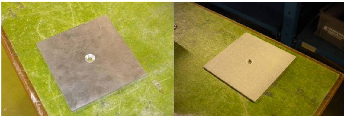
Abb. 7.77: Beschichtungsvorgang der Aluminium-Platte: Links: Platte, wie sie normalerweise für die Versuche verwendet wurde; Rechts: Mit Perth-Sand beschichtete Platte (unter Verwendung von doppelseitigem Klebeband)
