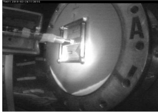
Abb. 7.10: Entfernen des Deckels inflight bei 10-facher Erdbeschleunigung. Zu sehen sind Sandreste, welche aufgrund von kleinen Undichtheiten herausrieseln konnten.
