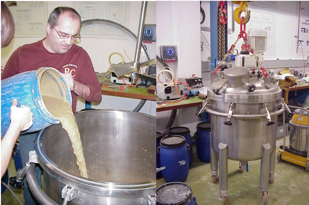
Abb. 4.36: Links: Der Tonschlamm wird in den Vakuum-Mixer eingefüllt. Rechts: Der Vakuum-Mixer.
