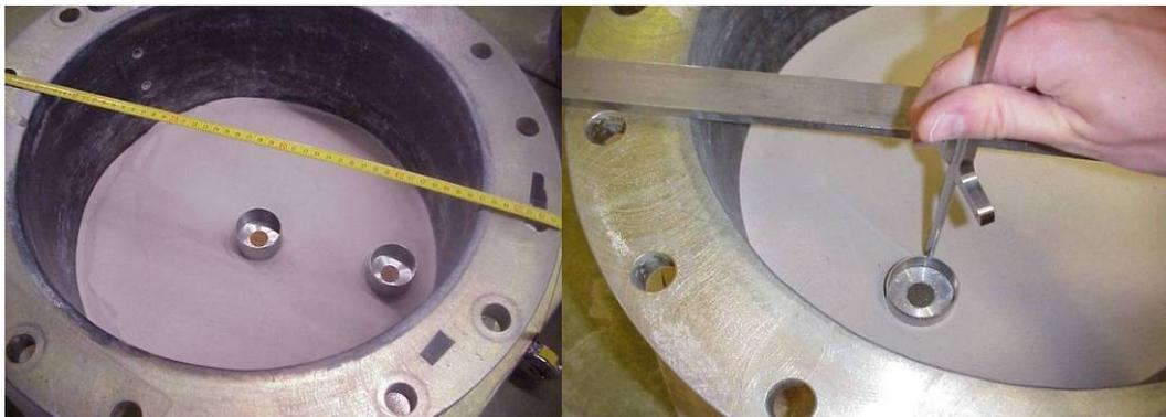
Abb. 4.35: Einbau und Einmessen der Lage der Bodentöpfchen mit einer Schublehre
