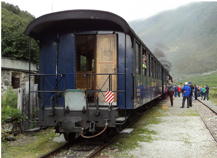
Abbildung 9.10 Rot-weiß gestreiftes Schweizer Zugschlussignal
