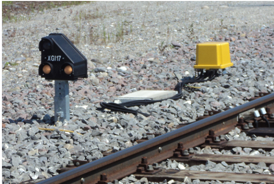
Abbildung 8.4 Zwergsignal Schweiz (Signalbegriff „Halt“)
