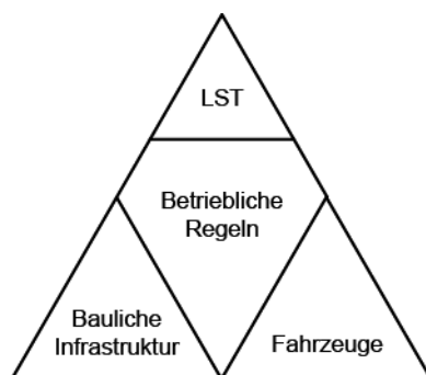
Abbildung 10.20 Darstellung des Betriebsverfahrens Zugverband nach [BOSSE 2010]
